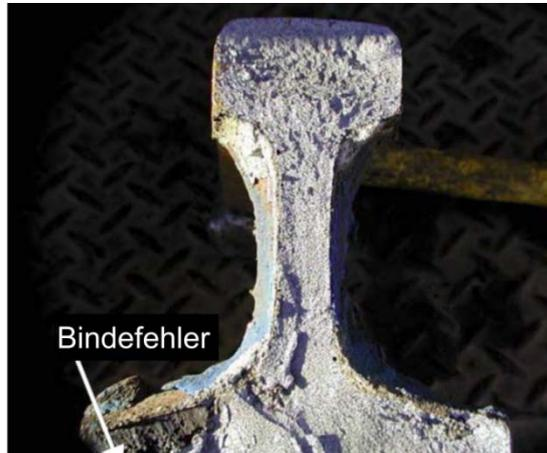
**Bild 13.** Bindefehler im Schienenfuß [39]
