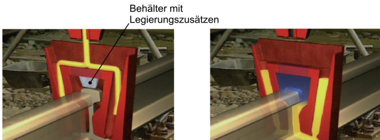
**Bild 16.** Thermit-Schweißen von kopfgehärteten Schienen [54]
