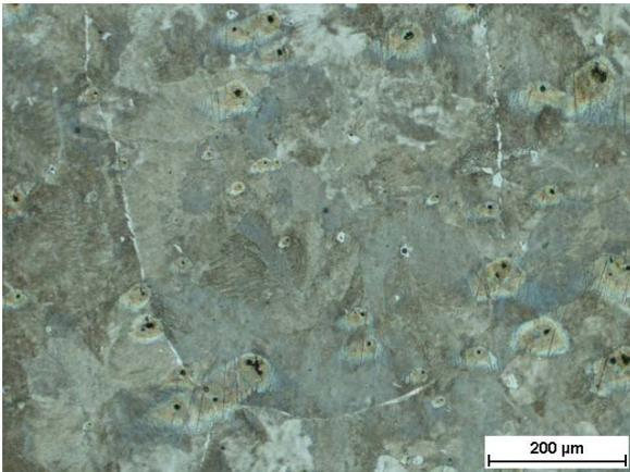
**Bild 64.** Gefügestruktur in der Schmelzzone der Schweißung 1
