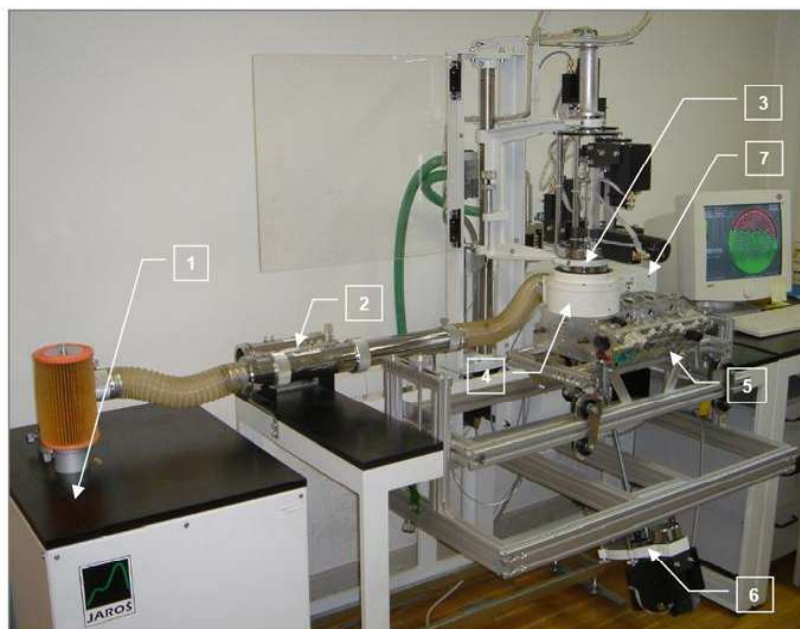
Bild A.5: Strömungsprüfstand des Instituts für Mobile Systeme der Otto-von-Guericke-Universität Magdeburg [Naumann 2007]
