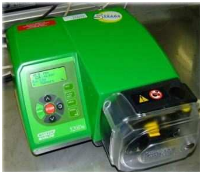
Fig. 3.4.2. Watson and Marlow peristaltic pump
