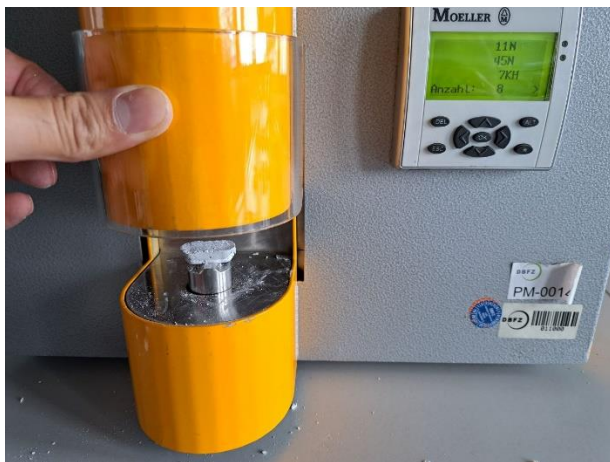
Abb 10: Härteprüfer zur Messung der Druckfestigkeit (c)
