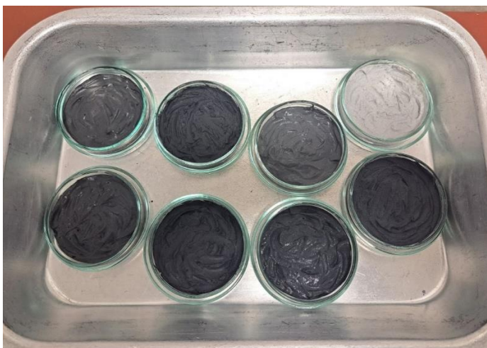
Abb 4: Zementleim von ausgewählten Proben (Proben von 6.1.1) in Petrischale vor der Trocknung im Ofen
