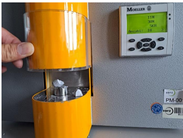
Abb 11: Härteprüfer zur Messung der Druckfestigkeit (d)
