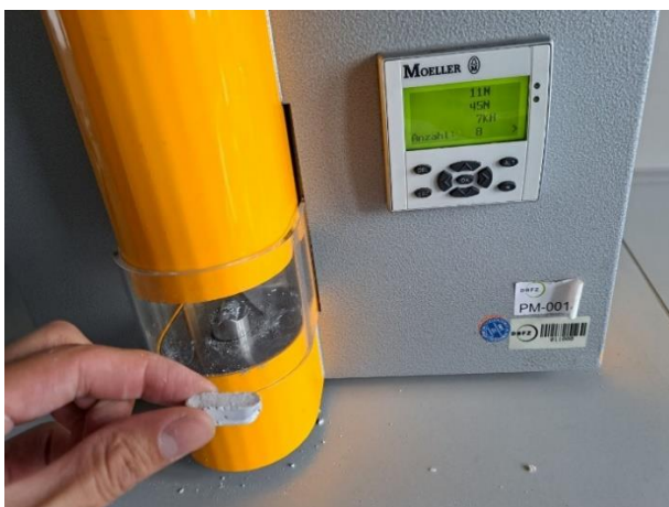
Abb 9: Härteprüfer zur Messung der Druckfestigkeit (b)
