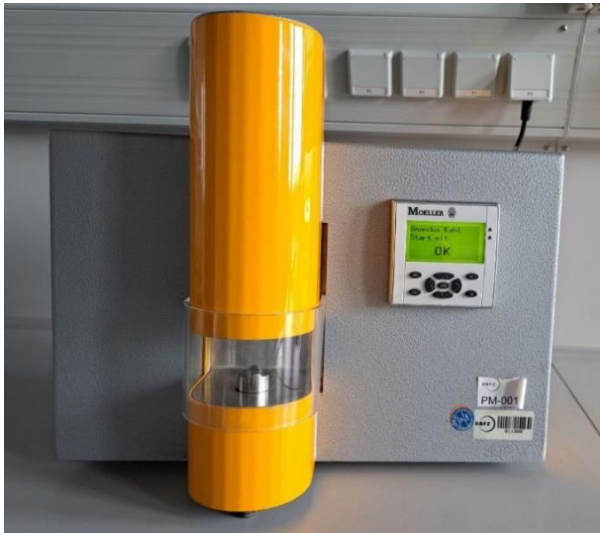
Abb 8: Härteprüfer zur Messung der Druckfestigkeit (a)
