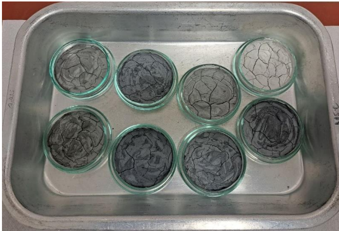
Abb 5: Zementleim von ausgewählten Proben (Proben von 6.1.1) in Petrischale Nach der Trocknung für 24 Stunden in Ofen
