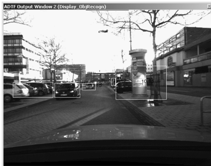
Abbildung 2-13: Probleme bei der Darstellung von Randbebauungen mit vorhandenen Objektmodellen.
