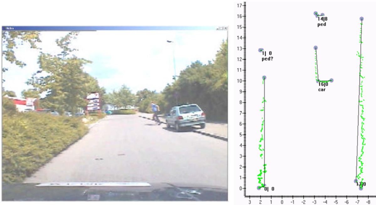
Abbildung 2-7: Umfeldwahrnehmung mit einem Laserscanner. Das Bild wurde aus [FUR0202] zur Veranschaulichung entnommen. Links: das Kamerabild von der Szene. Rechts: das parkende Fahrzeug wird als ein L-förmiges Objekt erkannt. Der Fußgänger dahinter wird auch erkannt und als Ped (Fußgänger) klassifiziert.
