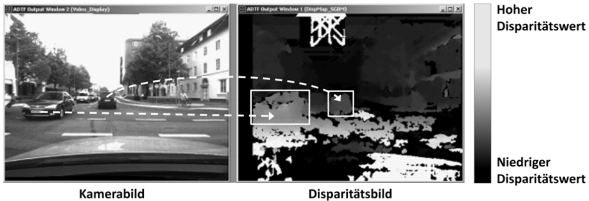
Abbildung 4-1: Ziel der Objektdetektion ist es, Pixel, die zu einem Objekt in realer Welt gehören, zu einem Segment zusammenzuführen.
