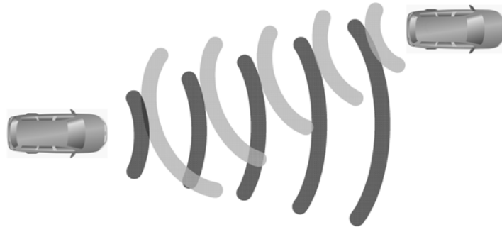
Abbildung 2-3: Funktionsprinzip des für ACC-Funktion eingesetzten Radarsensors
