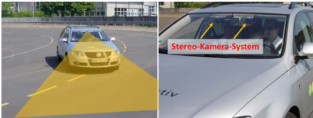
Abbildung 6-1: das Testfahrzeug mit dem eingesetzten Stereokamera-System
