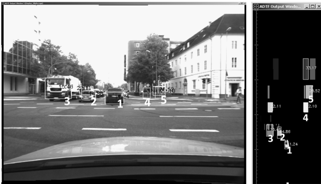
Abbildung 4-6: Objekte, die über das 2D-Histogramm segmentiert wurden, werden im Kamerabild zur Kontrolle veranschaulicht.
