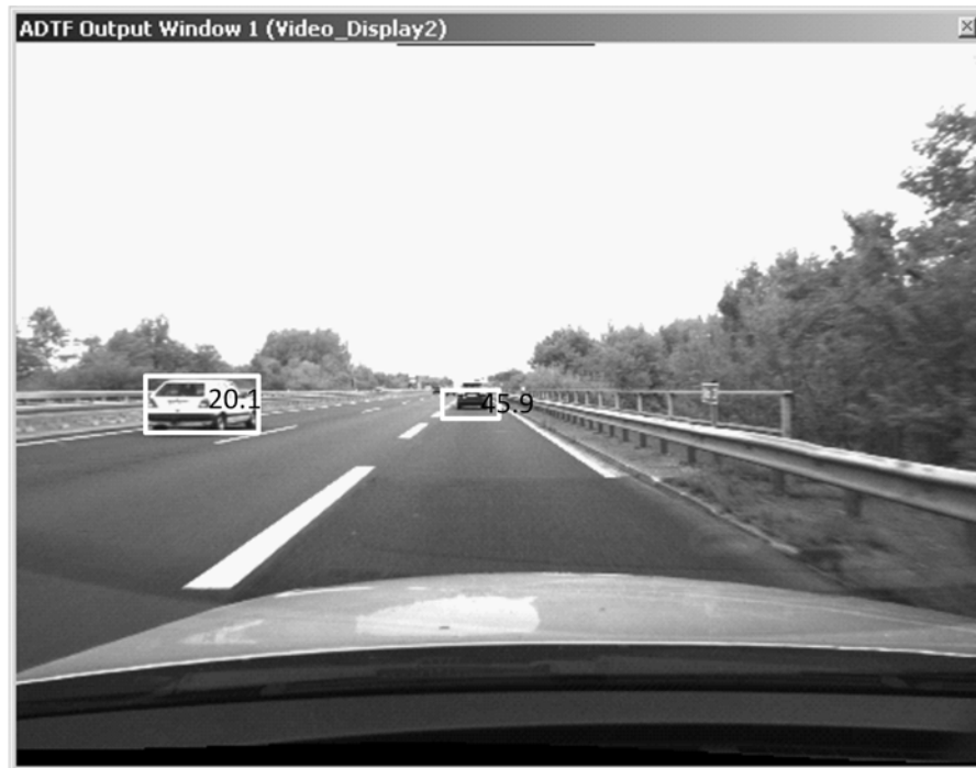
Abbildung 2-12: Objektbasierte Umfeldmodellierung auf der Autobahn. PKWs werden als Objekte mit Angaben von relativen Abständen dargestellt.
