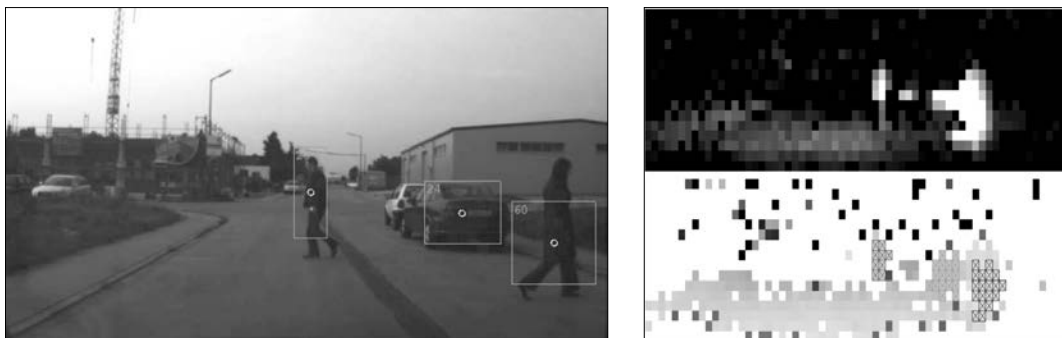
Abbildung 2-9: Umfeldwahrnehmung mit PMD-Sensor [ELI08]. Das linke Bild zeigt die mit PMD erkannten Objekte. Das obere rechte Bild stellt die Intensität der Reflexion dar. Das untere rechte Bild entspricht dem Entfernungsbild.
