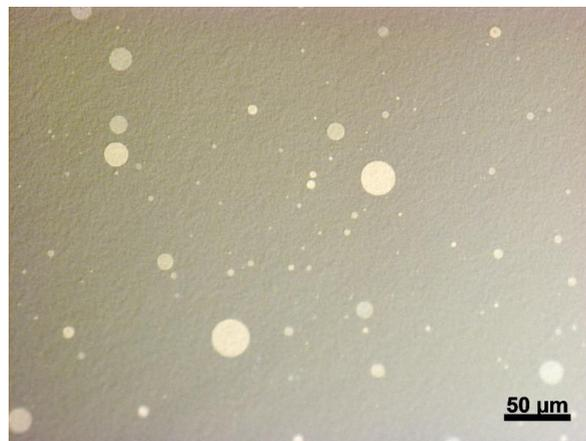
*Abbildung 5.1: Nomarski-Aufnahme mit 5-facher Vergrößerung von einer GaN Oberfläche mit Ablagerungen metallischen Galliums. Durch die Prozessführung mit Stickstoff als Reaktivgas werden die Galliumablagerungen hervorgerufen. Stickstoff bzw. Argonfluss war auf 90 bzw 100 sccm eingestellt.*
