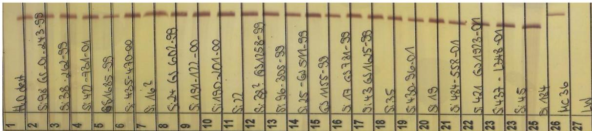
**Abbildung 11:** Mit Silbernitrat gefärbtes PAA-Gel nach *Bsr*GI-Restriktionsenzymverdau von Amplifikaten aus dem Exon 3 des ACADM-Gens.
