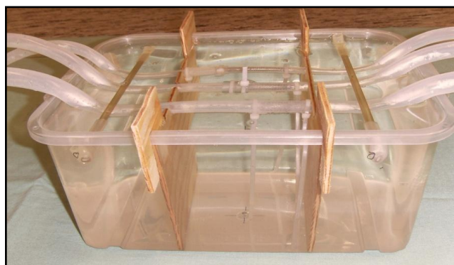
Abb.2: Seitliche Ansicht der mit Wasser gefüllten Wanne. Drei Versuchsschläuche sind mit Hilfe von zwei Holzgestellen parallel ausgerichtet.
