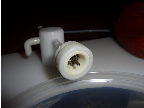
Abb. 5: Gefäßverbindungsadapter mit Metallröhrchen, welches die Gummimembran perforiert
