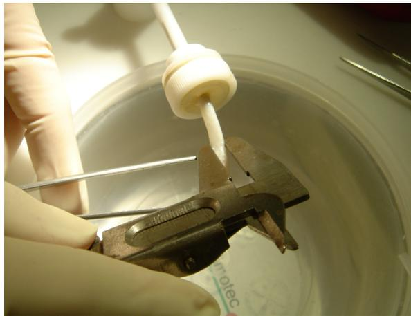
Abb. 10: Ermittlung des realen Gefäßdurchmessers
