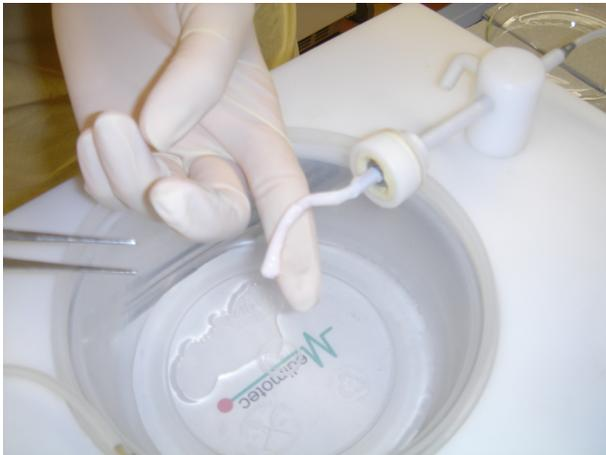
Abb. 6: Gefäß wird auf Metallröhrchen geschoben und liegt auf diesem auf
