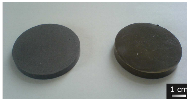
Abb. 4.16: Grünkörper des mit Ta (links) und TaC (rechts) gefüllten PMS-Polymers nach der Vernetzung bei einem Druck von 55 MPa und einer Temperatur von 200°C
