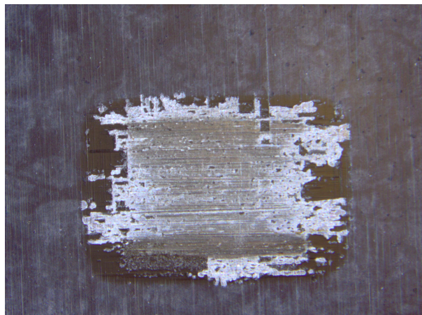
Abbildung 4.11: DLC-beschichteter Modellprüfkörper einer DLC-Selbstpaarung nach Versuchsende
