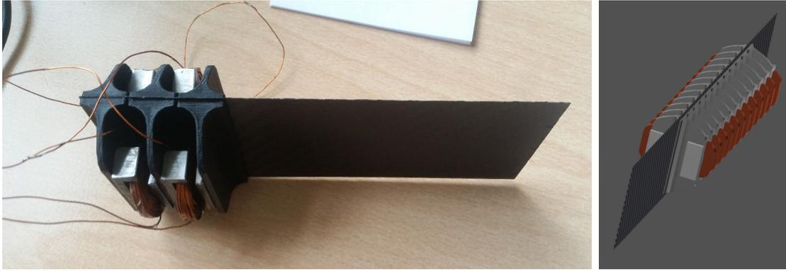
Abbildung 3.8: Konzept der elektromagnetischen Muskeln im Experiment und als 3D Modell
