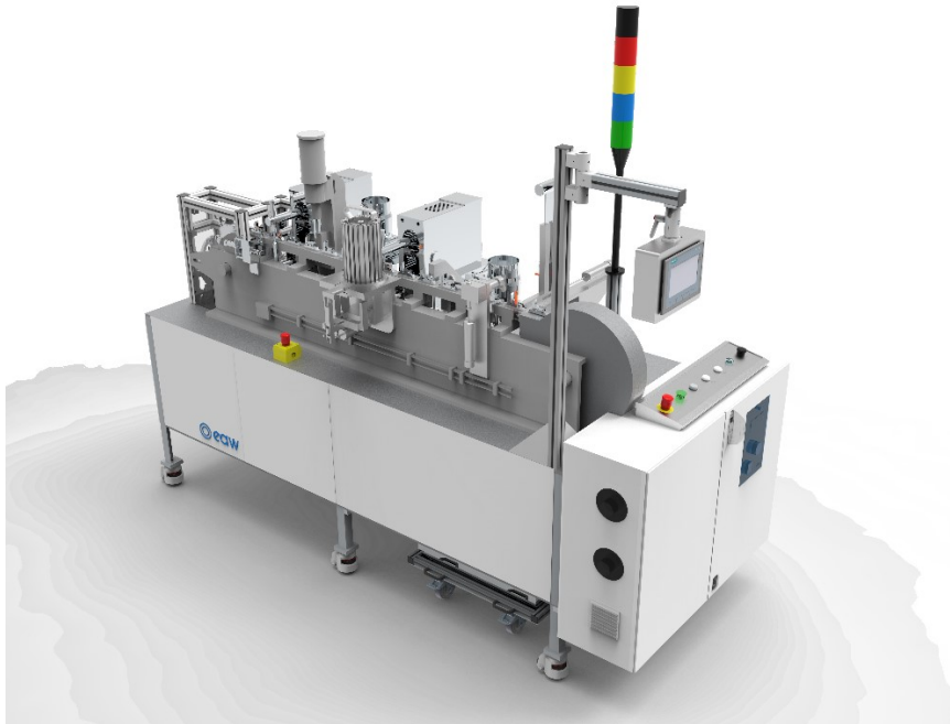
Abb. 2: Niet- und Schweißautomat der EAW Relaistechnik GmbH
