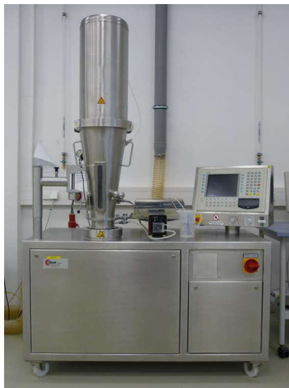
Abbildung 3.3: Aufbau Versuchsanlage GPCG 1.1. Coating-Einsatz
