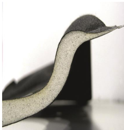
Bild 4: Querschnitt: verpresster Thermoformschaum
