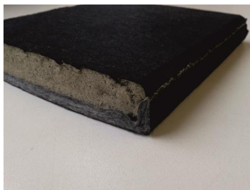
Bild 2: Hochabsorbierendes Sandwichmaterial der thermoakustischen Kapselung
