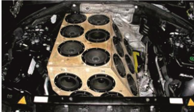
Abbildung 4: Messaufbau Kunstmotor im Motorraum
