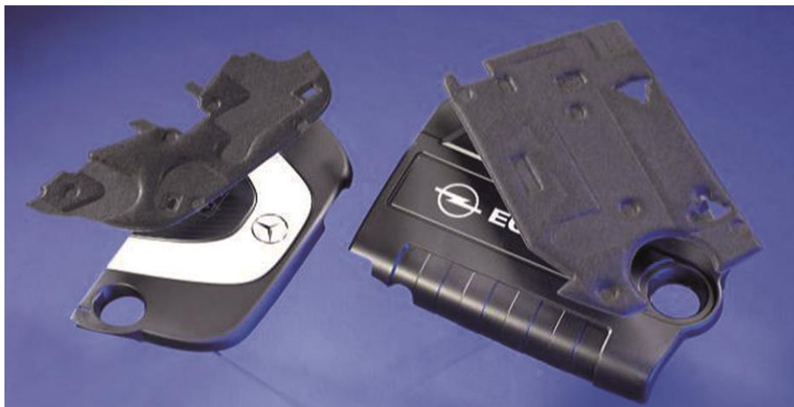
Bild 9: Motornahfeldschalen mit Basotect als Absorbermaterial bei Daimler und Opel
