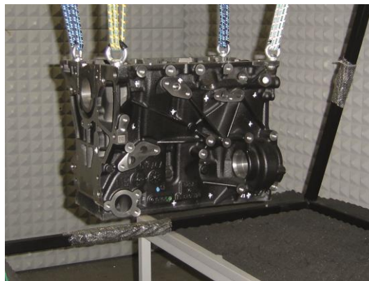
Bild 1: Messaufbau mit entkoppelt aufgehängtem Zylinderkurbelgehäuse
