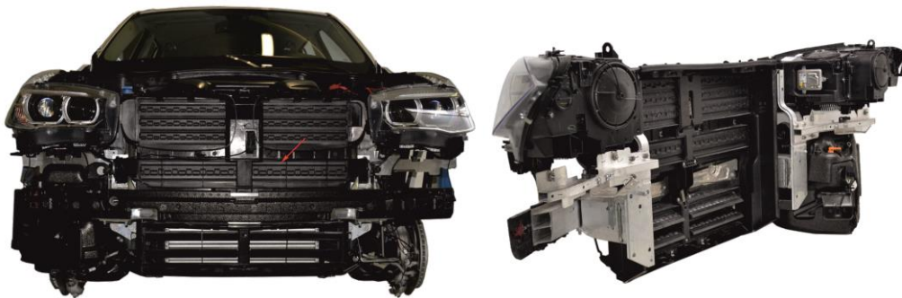
Bild 4: Kühlerjalousie als Bestandteil eines Motorkapselkonzeptes (Quelle A2mac1)
