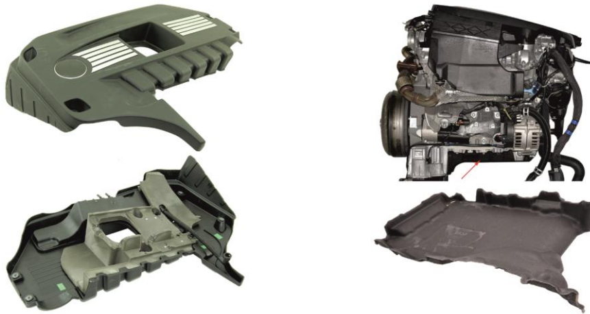
Bild 5: Am Antriebsstrang befestigte Maßnahmen (Quelle A2mac1)
