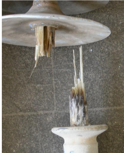
Abbildung 21: Mechanisches Versagen eines Isolators durch dauerhafte elektrische Entladungen
