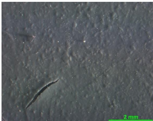
Abbildung 86: 40 BaS(1,3)/100 ATH/OS-I säuregealtert
