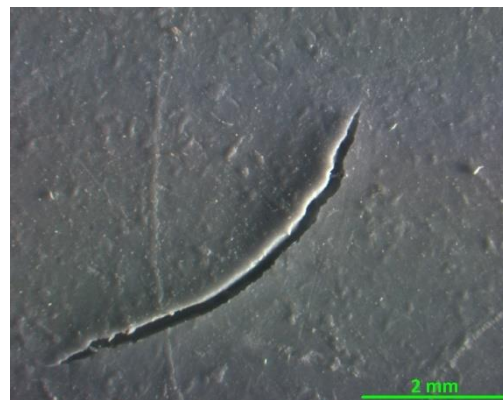
Abbildung 83: 20 BaS(4,0)/100 ATH/OS-I säuregealtert
