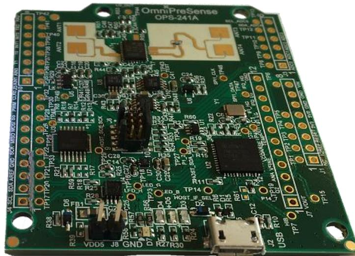
Abbildung 9: FMCW-Radar „OPS241-B Short Range FMCW Radar Sensor“ (übernommen von: OmniPreSense o.A.)
