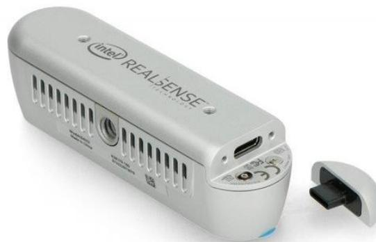
Abbildung 12: Tiefenkamera „Intel® RealSense™ Depth Camera D435i“ von hinten (übernommen von: BOTLAND B. DERKACZ SP. K. o.A.)
