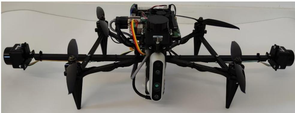
*Abbildung 53: Finaler Aufbau der Drohne*
