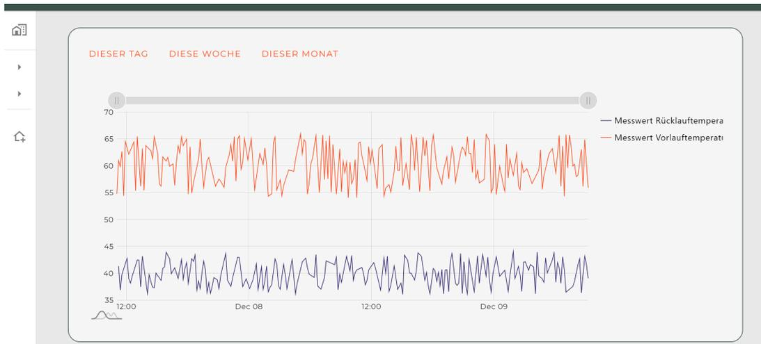
Abbildung 8.10: Trend der Vor- und Rücklauftemperatur eines Heizkreises
