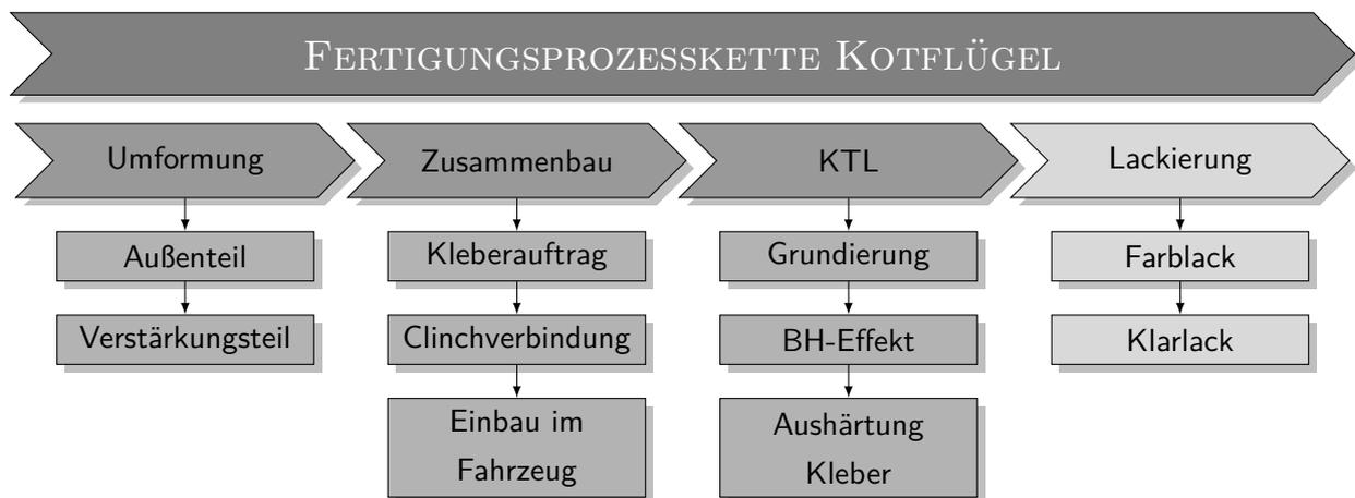
**Abb. 4-4:** Fertigungsprozesskette des Kotflügels
