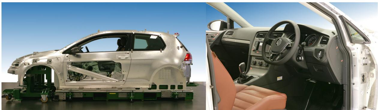
**Abb. 2-15:** Das Kombi-Cubing dient sowohl zur Qualifizierung von allen Interieur- als auch von bestimmten Exterieur-Bauteilen. Zu den Anbauteilen zählen u.a. die überwiegend aus Kunststoff und Glas gefertigten Stoßfänger, Scheinwerfer, Scheiben, Fensterschachtleisten, Blenden und Dichtungen. [32]
