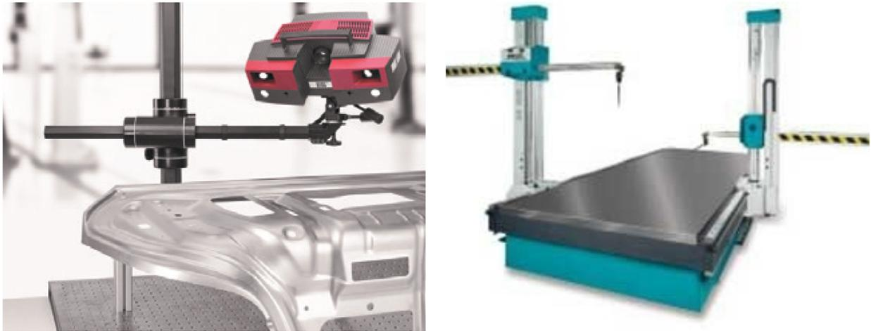
**Abb. 2-13:** Links: Optisches Messsystem ATOS Triple Scan von GOM [30, S. 53] | Rechts: Messplatte mit zwei taktilen Koordinatenmessgeräten in Ständerbauweise [31]
