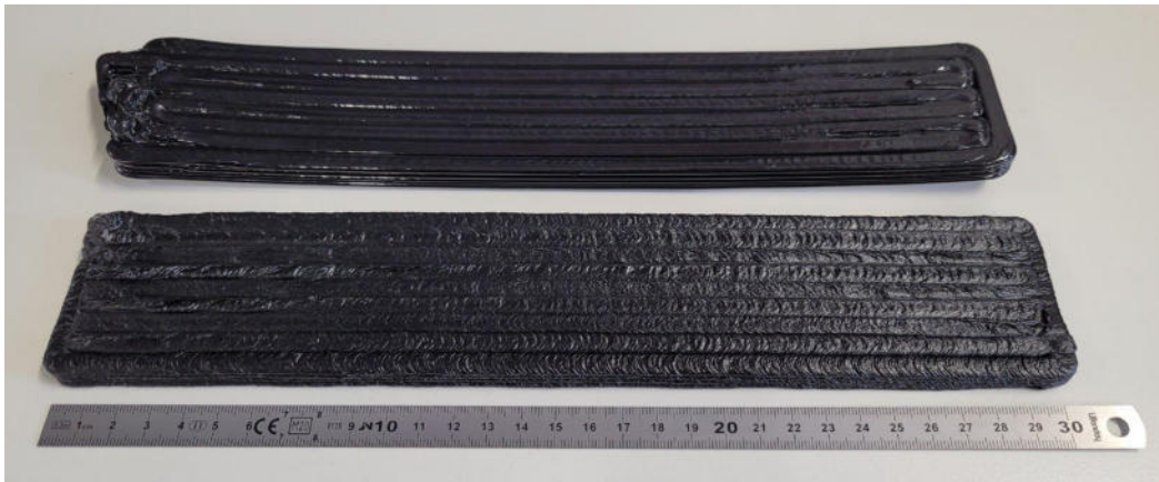
Abb. 13: Probekörper; oben: PC-ABS; unten: PC-ABS-GF
