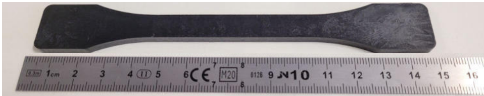
Abb. 15: spritzgegossene Zugprobe aus PC-ABS-GF
