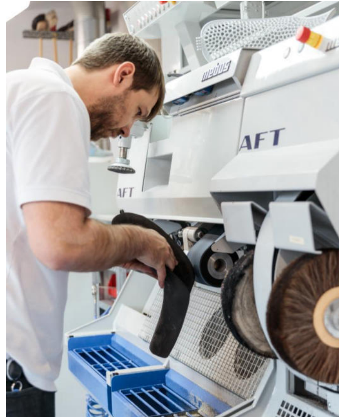
Konventionelle Herstellung: Links: Gipsabformung des Unterschenkel-Fuß-Bereiches. Mitte: Schleifen eines Orthesenteils. Rechts: Konventionelle, maßgefertigte Zwei-Schalen-Orthese.
