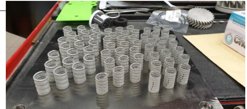
PBF-LB/M Teile nach Entpulvern
