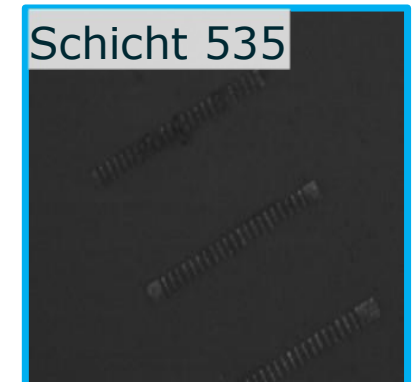
Schichtbilder aus OEM-System mit Auflösung von 293\ \mu\text{m}/\text{Pixel}
