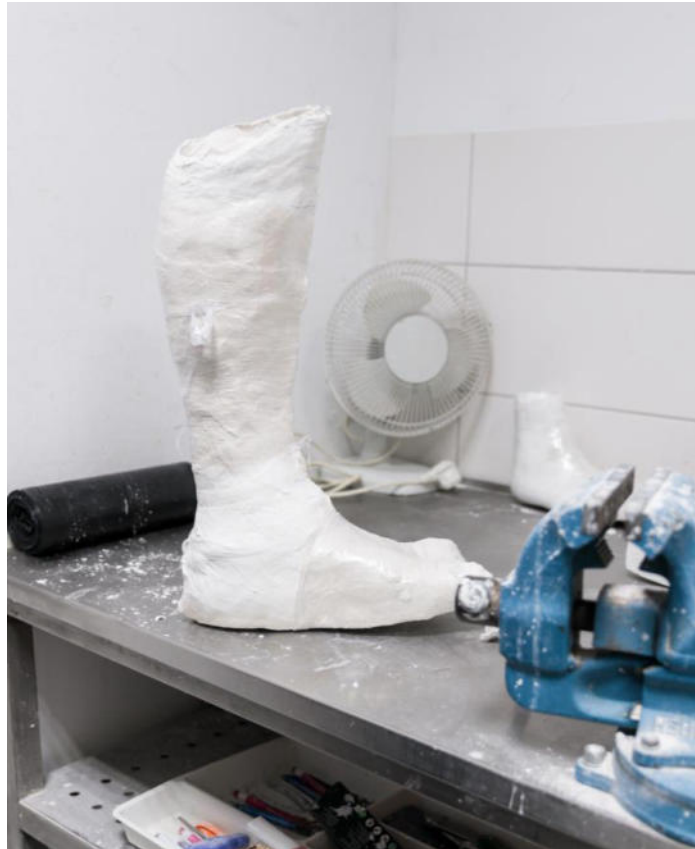
Konventionelle Herstellung: Links: Gipsabformung des Unterschenkel-Fuß-Bereiches. Mitte: Schleifen eines Orthesenteils. Rechts: Konventionelle, maßgefertigte Zwei-Schalen-Orthese.
