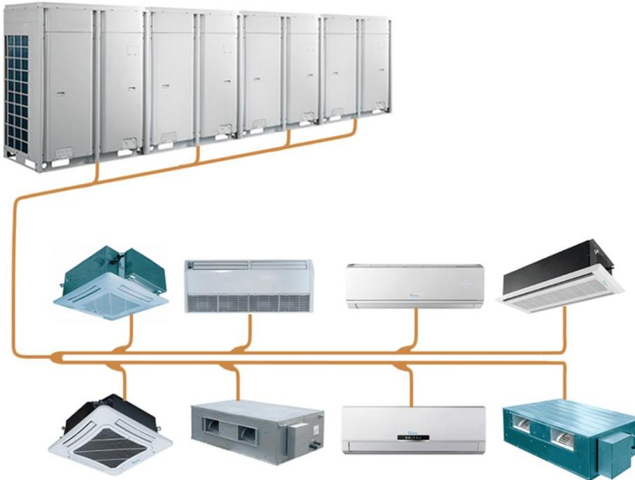
Abbildung 19: Verbindung zwischen Außeneinheit und Inneneinheiten in dem VRF-Klimasystem [19]
