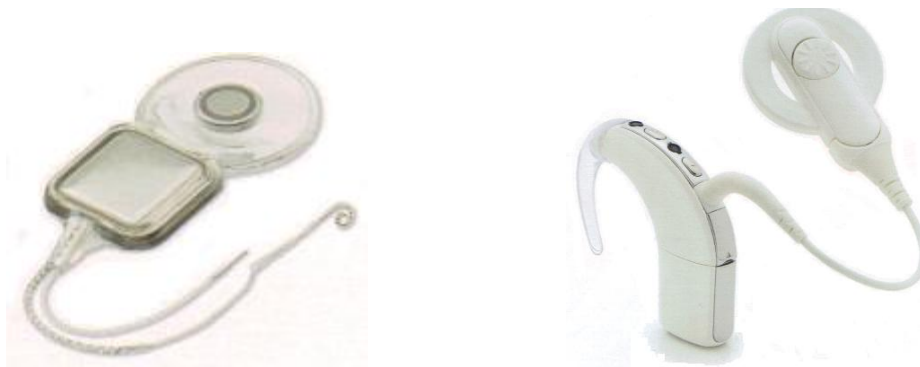
Abb. 4: interne und externe Komponenten eines Cochlea-Implantats-Systems ( Cochlear™ Nucleus® Serie CI500 Implantat und CP810 Soundprozessor)
