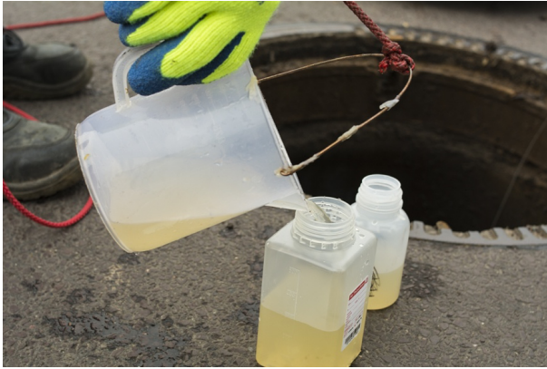
Abbildung 6: Umfüllen der Probe in Na-Thiosulfat zur Konservierung.
