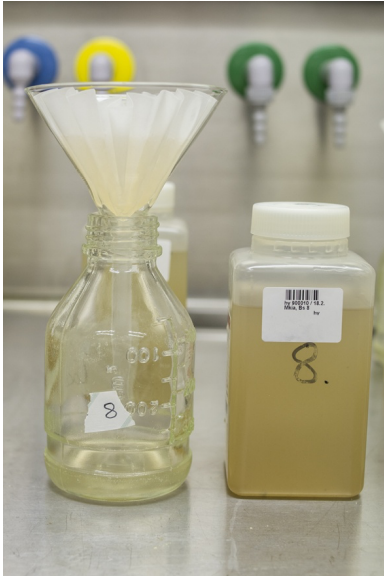
Abbildung 7: Vor-Filtration mit Whatman-Filter. Das Abwasser wurde auf das Filterpapier gegeben und vorfiltriert.
