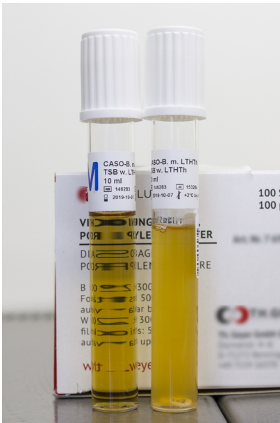
Abbildung 11: Bouillon vor und nach Inkubation bei 35 \pm 1 °C. Links ist die Bouillon noch unbeimpft und klar. Rechts ist die Bouillon nach Beimpfung, mit Antibiotikum versetzt und für ca. 24 Std. inkubiert, getrübt.
