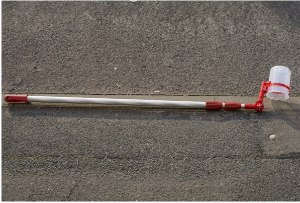
Abbildung 3: Probenahmehilfsmittel 1. Hiermit wurden Abwasserproben genommen.
