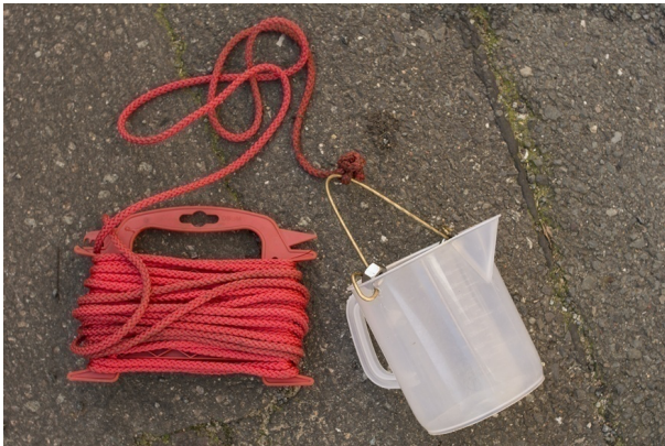
Abbildung 4: Probenahmehilfsmittel 2. Hiermit wurden Abwasserproben genommen, wenn der Abnahmeschacht sehr tief lag.
