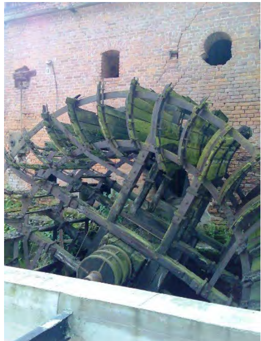
Abbildung 6 Wallendorf/ Luppe. Zuppinger-Wasserrad. (Zwanziger 2010)
