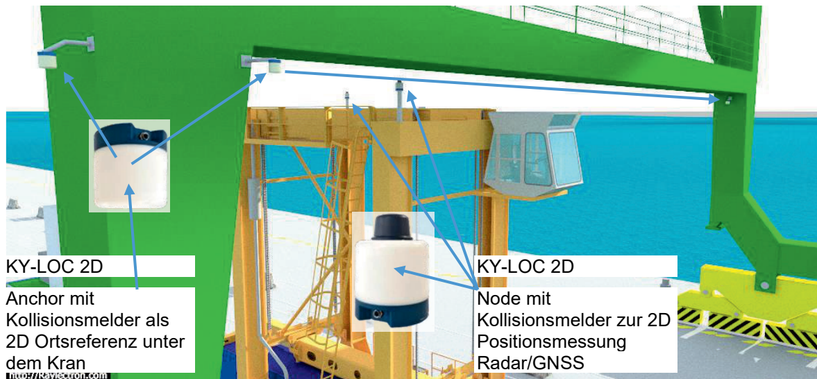
Bild 10: Radar zur 2D Positionsbestimmung und Kollisionsvermeidung zwischen Kranen, Last und Fahrzeugen
