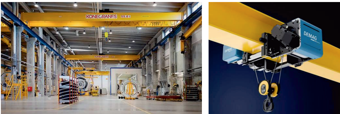
Bild 1: Beispiel eines Zweibrückenkrans mit Seilzug (links) [1] und eines Elektroseilzugs als Hebezeug (rechts) [2]
