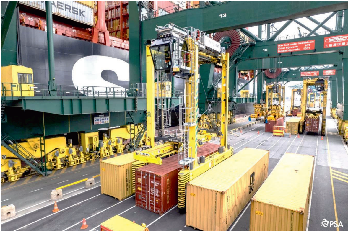
Bild 8: Gefährliche Lastwechsel zwischen Transportfahrzeugen (gelb) unter großen Containerkranen (grün) [PSA]
