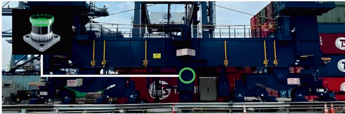
Bild 7: Blick in Portal-Katzfahrtrichtung, mit Scanebenen in beiden Portal-Fahrtrichtungen
