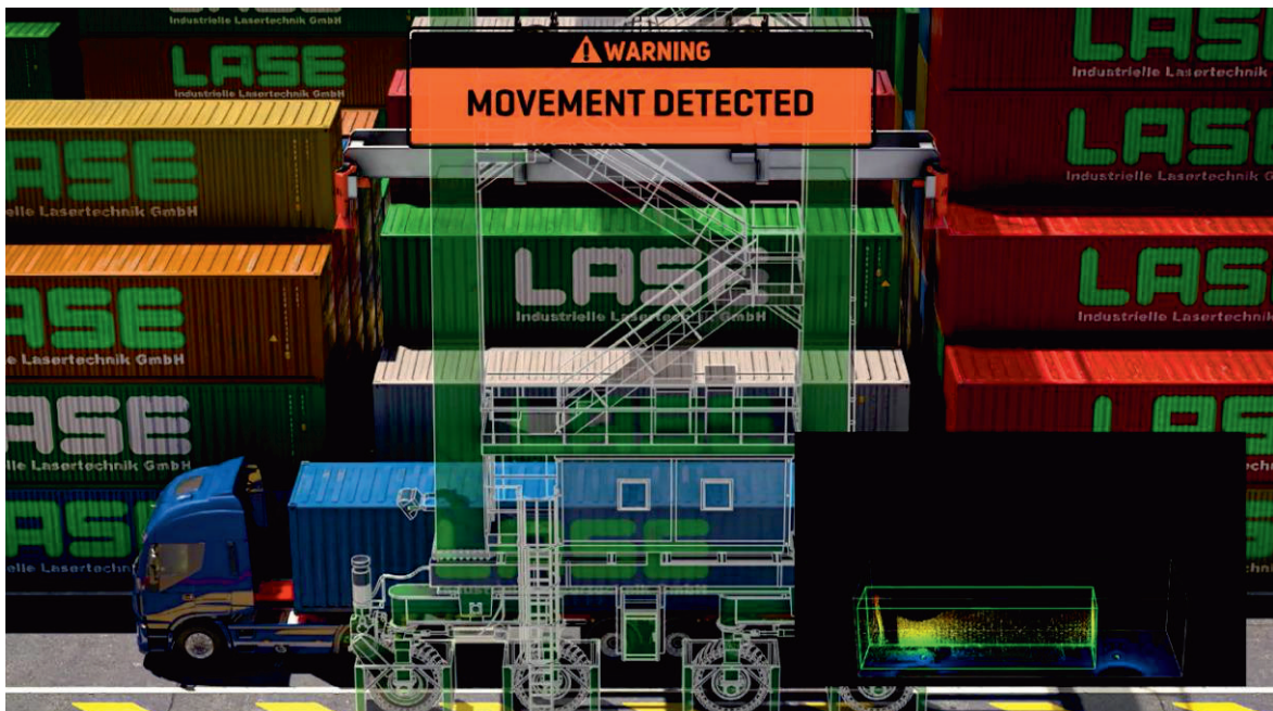
Bild 13: Not-Stopp bei Detektion eines Chassis Lifts
