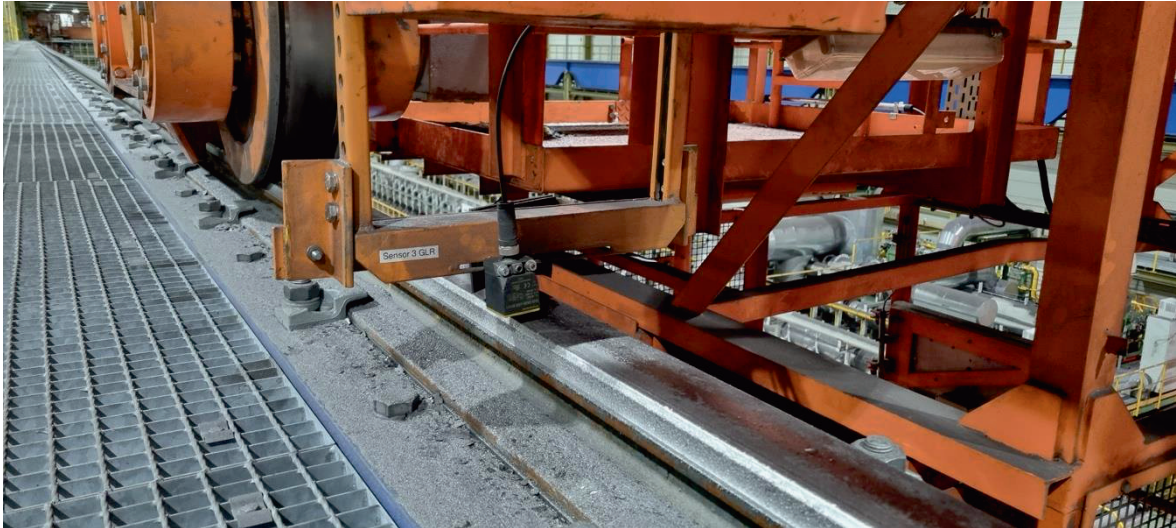
Bild 3: Schiene mit Laufrädern und Abrieb [Lehnert Regelungstechnik GmbH]
