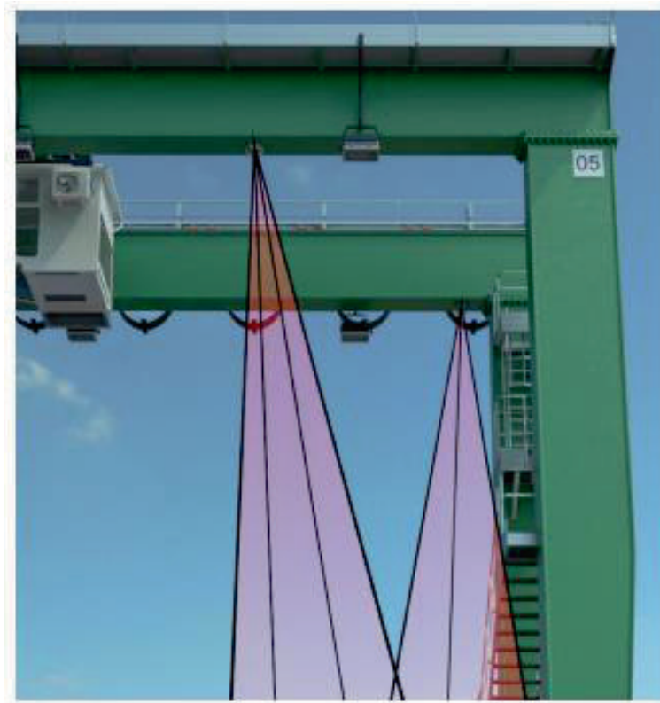
Bild 3: Montage über Fahrspur eines RTG für die Überwachung des Be- und Entladevorgangs
