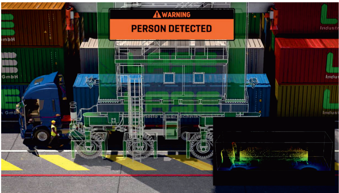
Bild 18: Not-Stop bei Detektion einer Personen-Identifizierung
