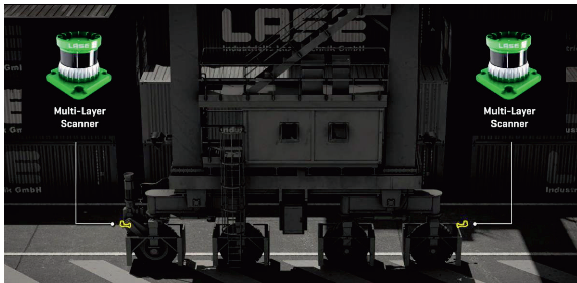
Bild 4: Montage am Fahrwerk eines RTG zur LKW-Anhebeprävention, Kranfahrerkollisionsprävention, LKW-Positionierung, Fahrerhauserkennung und LKW-Bewegungserkennung
