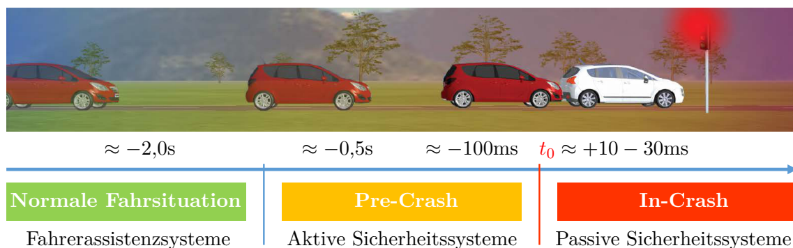
Abbildung 4.5. – Aufgezeigt wird die manöverbasierte Einstufung der Phasen eines Unfalls inklusive Fahrerassistenz- und entsprechend auslösender Sicherheitssysteme (nach [101], [88] und [102]).
