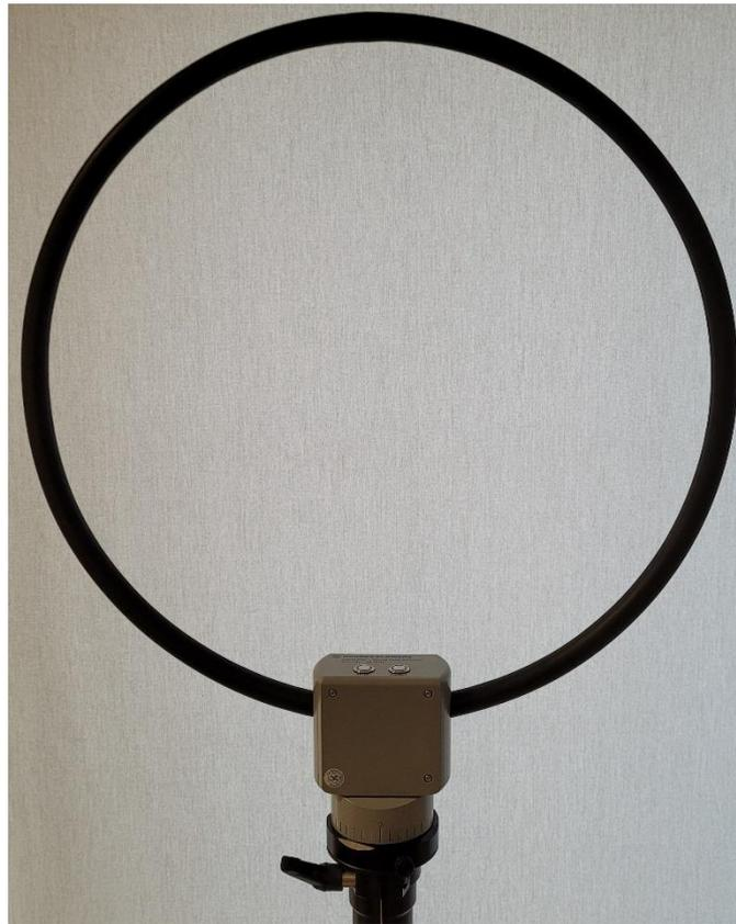
Abbildung 7 - Loopantenne HFH2-Z2E der Firma Rohde & Schwarz
