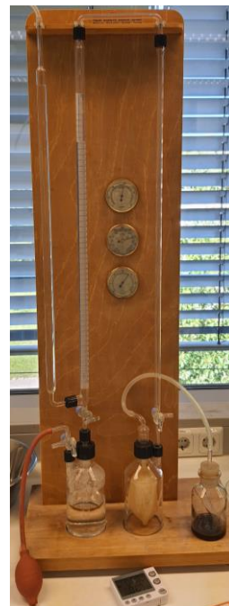
Abb. 27 CO 2 -Gasometer im Labor
