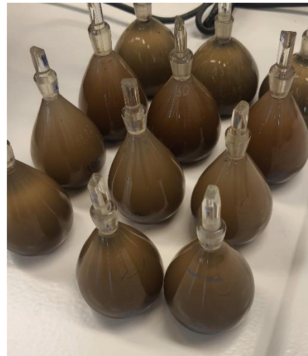
Abb. 25 Mit Proben gefüllte Pyknometer
