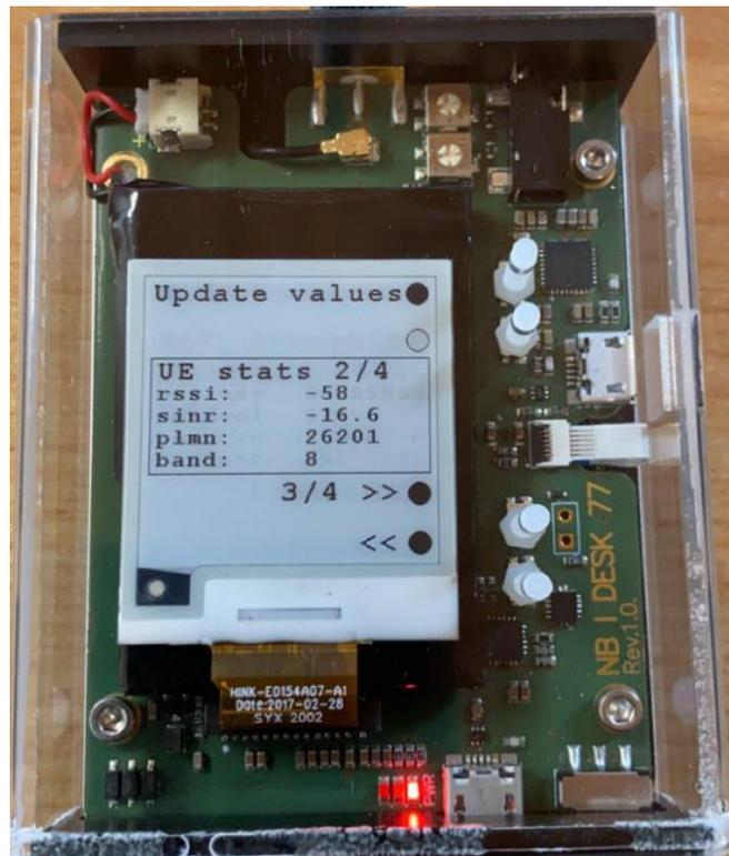
Abbildung A.9: Signalparameter mit dem NB-DESK77 abgerufen
