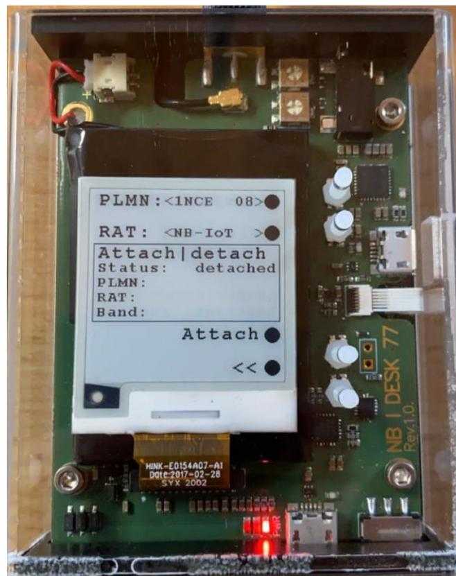
Abbildung A.5: NB-DESK77 Verbindungsaufbau
