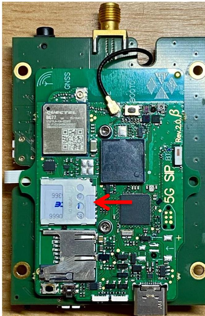
Abbildung A.3: SIM-Kartenslot auf der Unterseite der Platine
