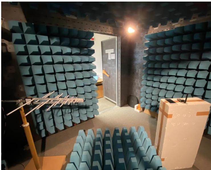
Abbildung 31: Messaufbau in der Schirmkabine mit geöffneter Tür
