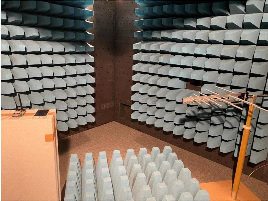
Abbildung 30: Messaufbau in der Schirmkabine
