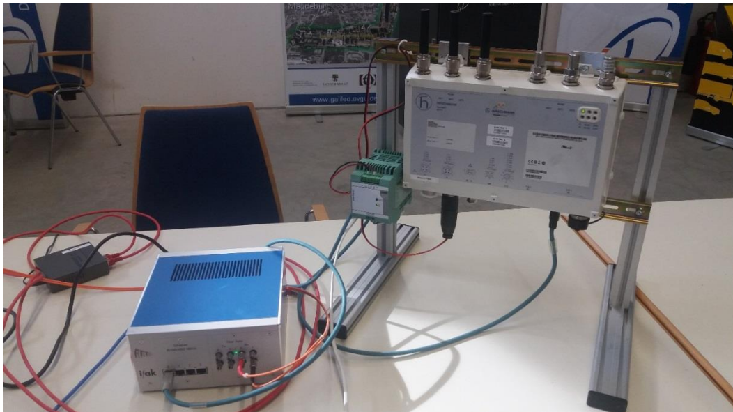
Abbildung 3.7: Access-Point Funknetzwerk mit Multiface
