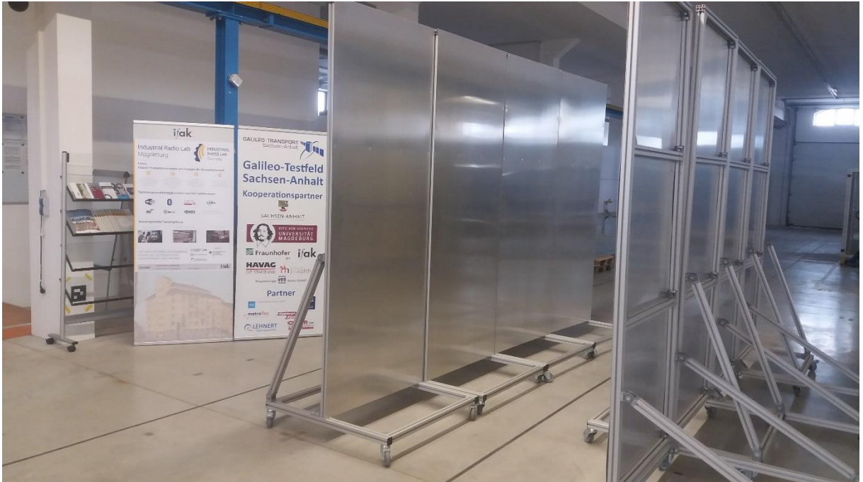
Abbildung A.3: Aufbau der Reflexionsflächen auf beiden Seiten
