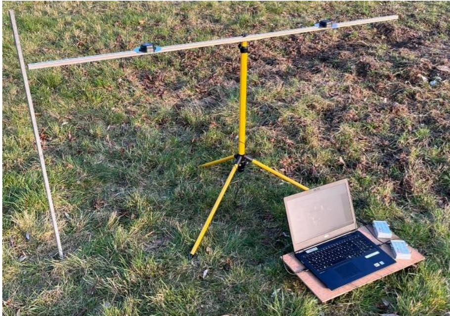
Abbildung 22 Messaufbau der Richtungsmessung mit drehbarer Metallschiene
