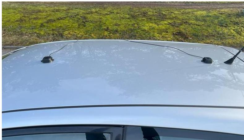
Abbildung 16 Platzierung der Antennen auf dem Autodach
