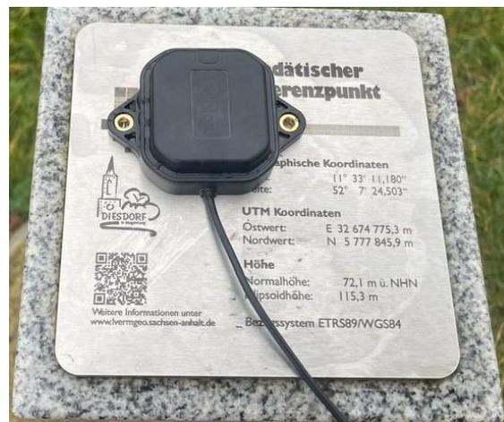
Abbildung 25 Georeferenzstein mit Messantenne
