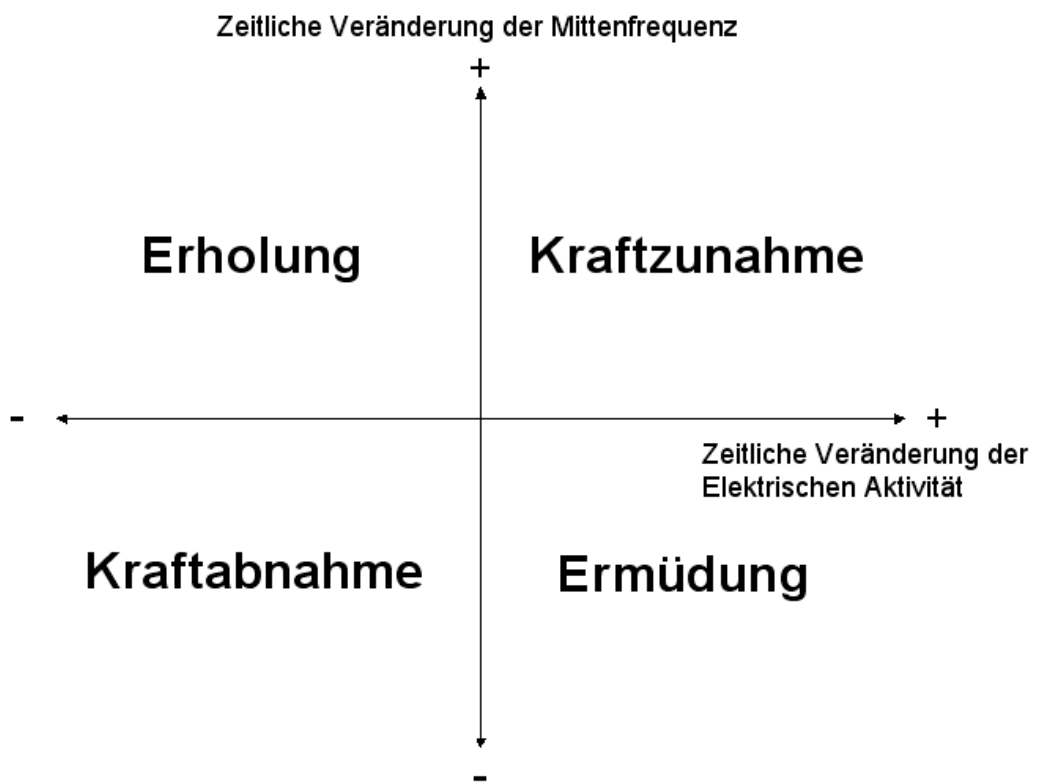
Abb. 1: Schematische Darstellung der Methode zur: „ Joint Analysis of EMG Spectrum and Amplitude = JASA“ (Luttmann et al. 2000)
