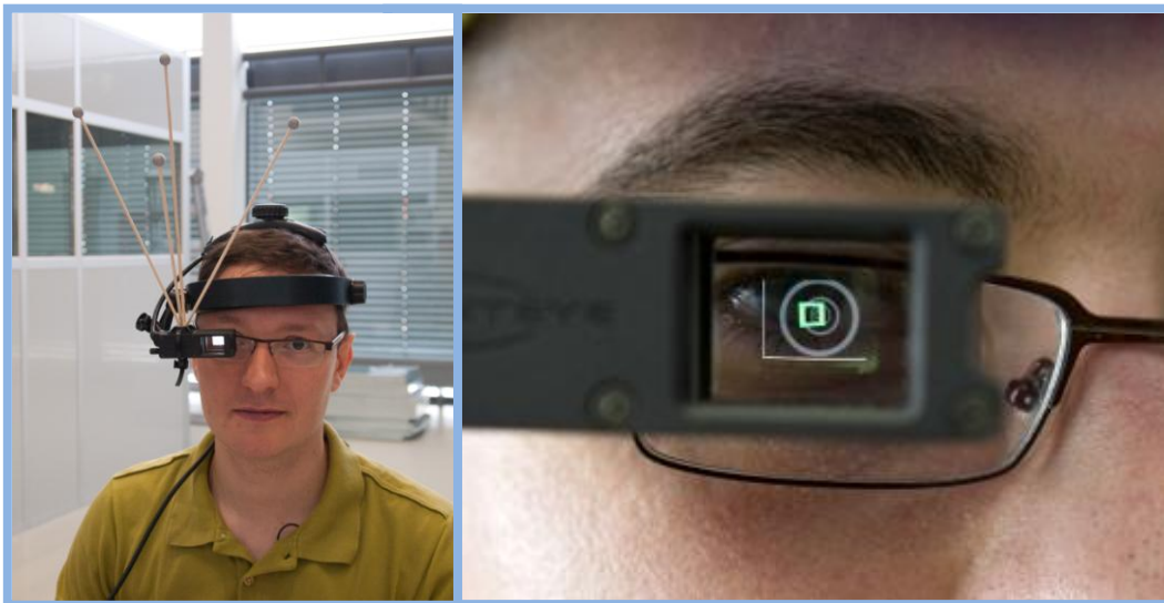
Abbildung 17: Aufbau des HMD mit Trackingsystem sowie die Visualisierung am Liteye
