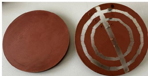
**Bild 2:** Scheibe-Scheibe mit Beschichtung für drei Kondensatoren,  $d_{\text{außen}} = 120 \text{ mm}$
