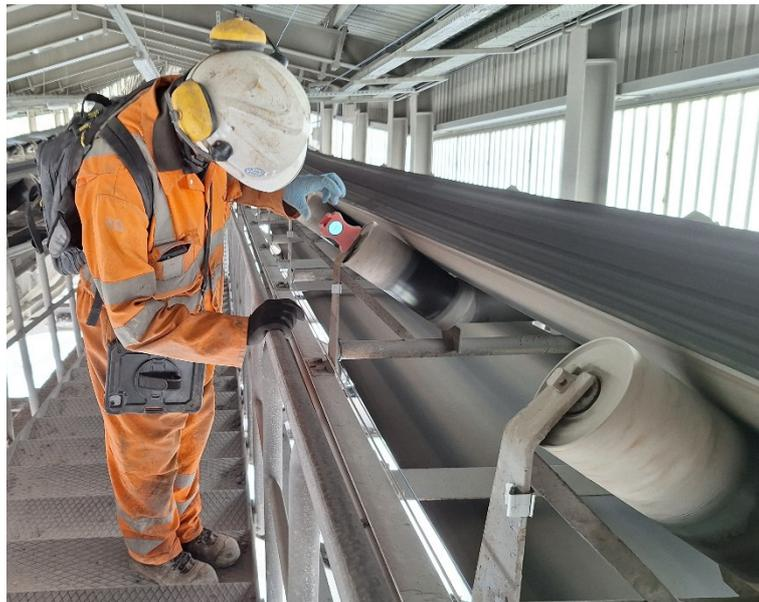
**Bild 4:** Anwender mit MCube RFP-Handgerät während einer Routineinspektion [9]
