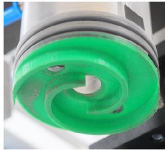
**Bild 7:** Kratzergeometrie mit Kratzerblättern, die einer archimedischen Spirale folgen
