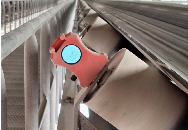
**Bild 2:** Mobiler Einsatz mit Handgerät an laufender Förderanlage [9]
