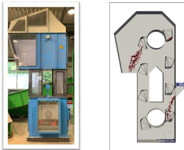
**Bild 1:** Becherwerk - links: real; rechts: Simulation
