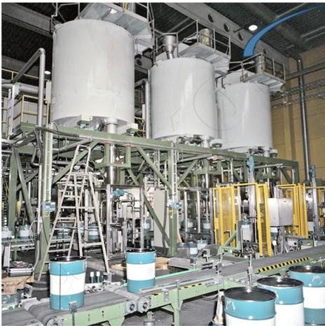
Homogenisierung Nichteisen-Metallpulver: Drehfrequenz mindestens 8 rpm
