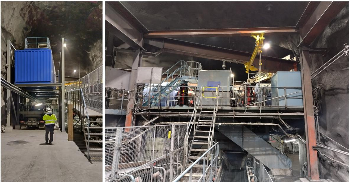
**Bild 9:** Installiertes E-Haus für Frequenzumrichter (links) und Blick auf die Antriebsstation mit 2 x 1625 kW / 2 x 360 kNm Permanentmagnet–Drehmomentmotoren (rechts)
