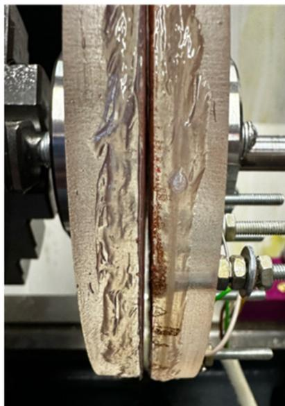
**Bild 8:** Luftspalt am vertikalen Teil der Labyrinthdichtung (Scheibe-Scheibe),
