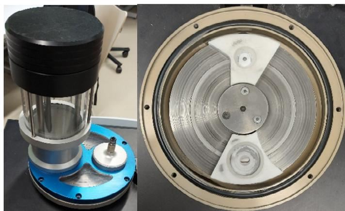
**Bild 5:** Standardpulverförderer von GTV
