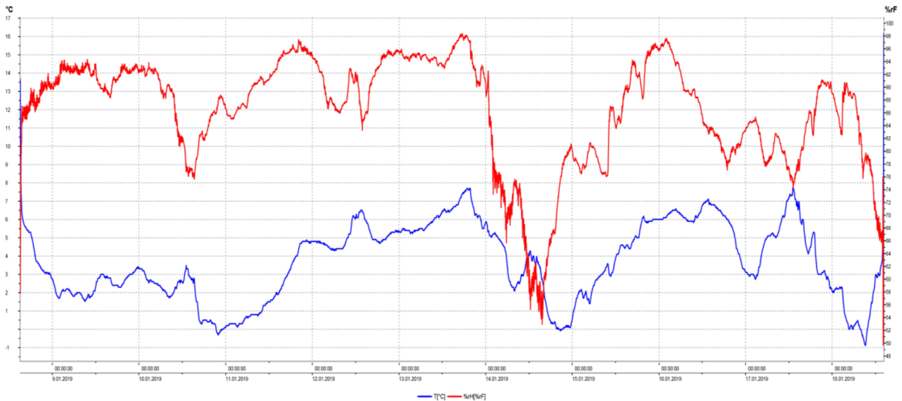
Abbildung A-11: Umgebungstemperatur und relative Feuchte in der Versuchsgometrie des Großversuchsstands im Zeitraum 09. bis 18. Januar 2019
