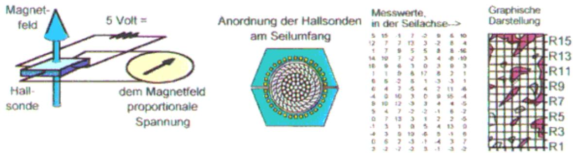
Abbildung 2-5: Drahtseilprüfung mit Hall-Sonden [22]
