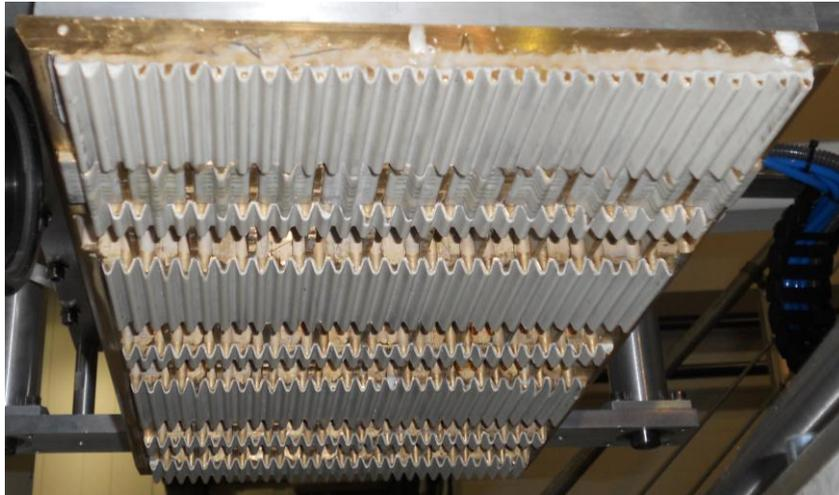
Abbildung 7-2: Trägerplatte unbestückt
