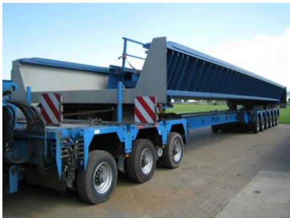
Abb. 1: Genehmigter Sondertransport einer im SCHACHTBAU Nordhausen gefertigten Eisenbahnbrücke.
