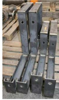
Abb. 12: Bohrmilch auf den Bauteilen. Mit freundlicher Genehmigung der Fa. Stahlbau Peters.
