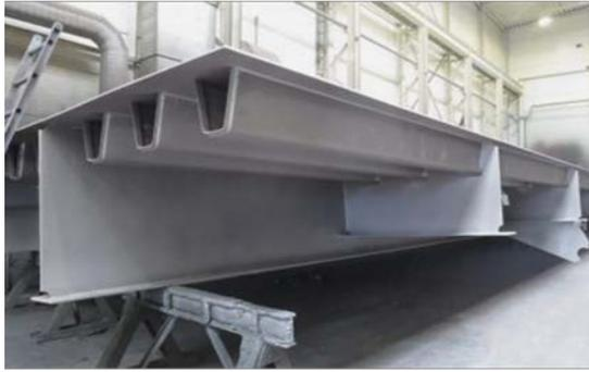
Abb. 11: Gestrahltes Bauteil. Mit freundlicher Genehmigung der Fa. SEH Engineering GmbH.
