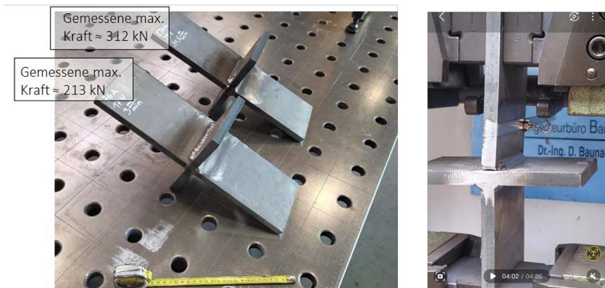
*Abb. 4: Kreuzzugproben vor und während der Prüfung, jeweils an 15 mm dickem Blech aus S355J2 mit einer vorgegebenen Kehlnaht  $a = 4$  mm.*
