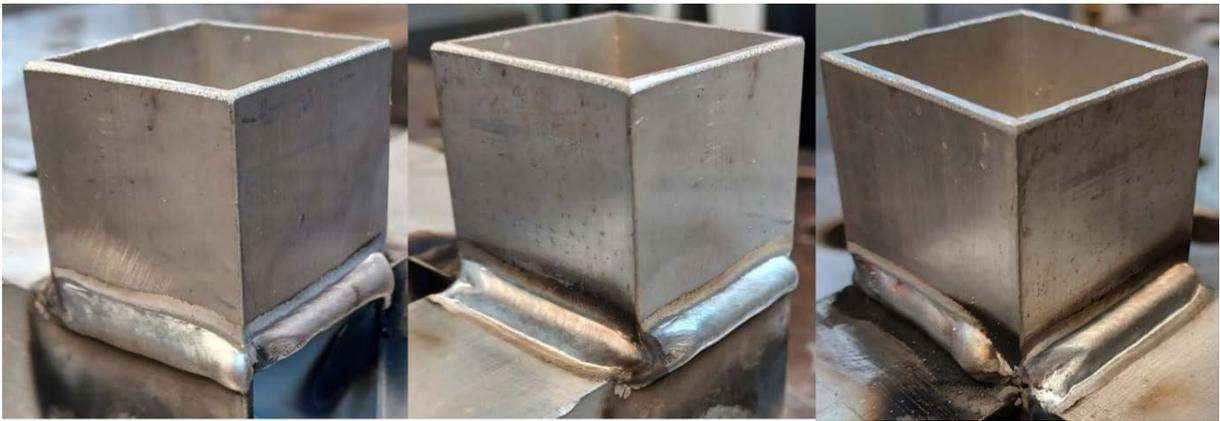
Abb. 4: Beispiel für verschweißte AlMgSi0,5-Profile (Zusatzwerkstoff: AlMg4.5Mn, energiereduzierte Kurzlichtbogen mit reversierender Drahtbewegung)
