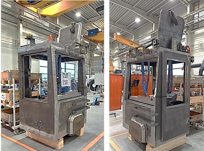
*Abb. 3: Kabine mit ca. 100 mm dicken Stahlwänden und Türen mit einem Gesamtgewicht von ca. 9 t und einem Gewicht des abgebildeten Bauzustandes von ca. 6 t mit deutlich erkennbaren blecheben geschliffenen, geschweißten Vollanschlüssen.*
