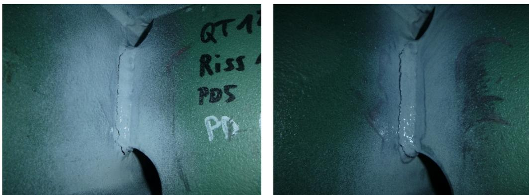
*Abb. 5: Rissausgangspunkt am Freischnitt einer älteren Brücke.*
