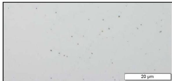
*Bild 6: Mikroeinschlüsse im UP-Schweißgut mit O = 0,032 %; Flux 10, DC-, E = 10 kJ/cm, U<sub>s</sub> = 28 V, Ferritanteil 2,3 FN.*
