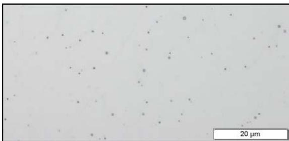
*Bild 5: Mikroeinschlüsse im UP-Schweißgut mit O = 0,045 %; Flux 9, AC mod., E = 10 kJ/cm, U<sub>s</sub> = 28 V, Ferritanteil 3 FN.*
