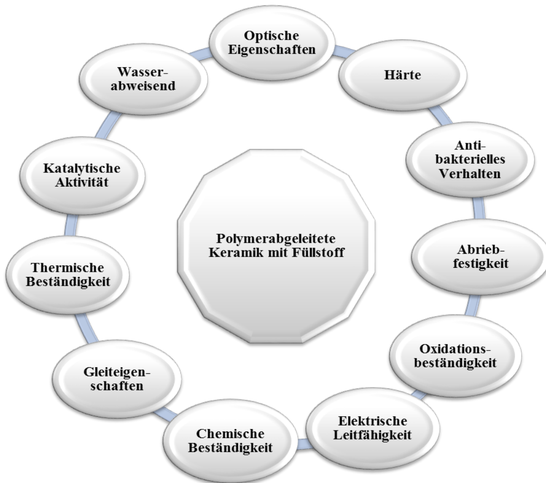
Abbildung 2.3: Wichtige Eigenschaften von Formteilen und Beschichtungen aus präkeramischen Polymeren durch Zugabe spezieller Füllstoffe (eigene Darstellung nach[4])
