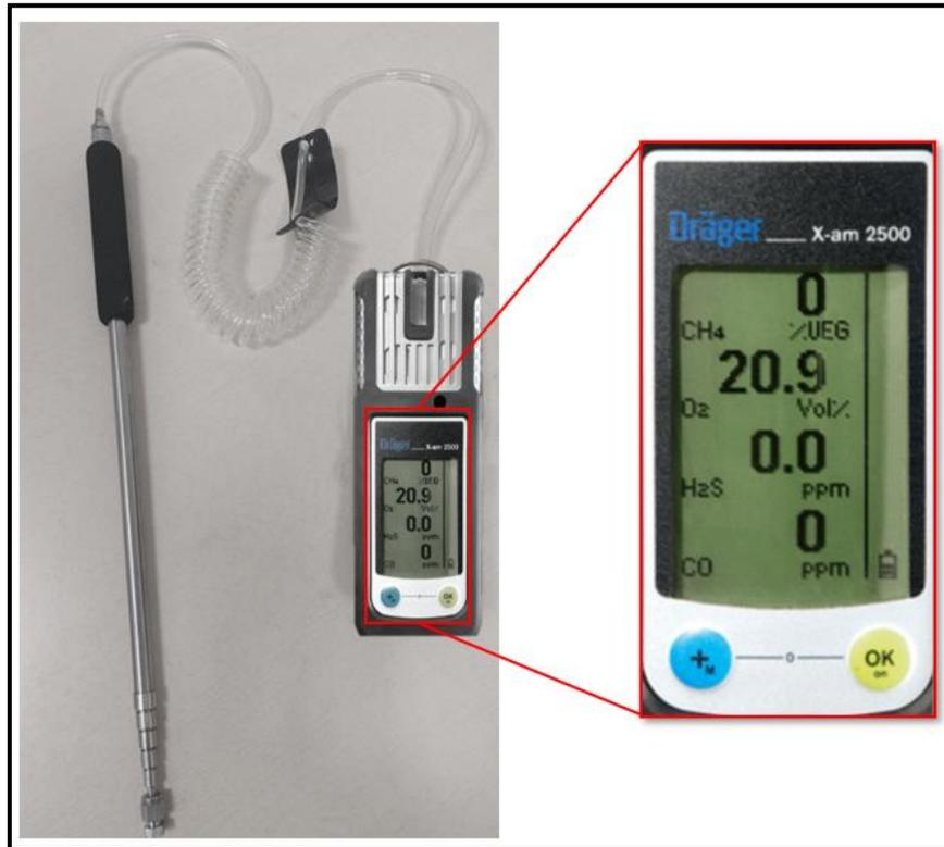
**Abbildung 90:** Mehrgasmessgerät inkl. Messsonde zur Ermittlung von Sauerstoffkennwerten
