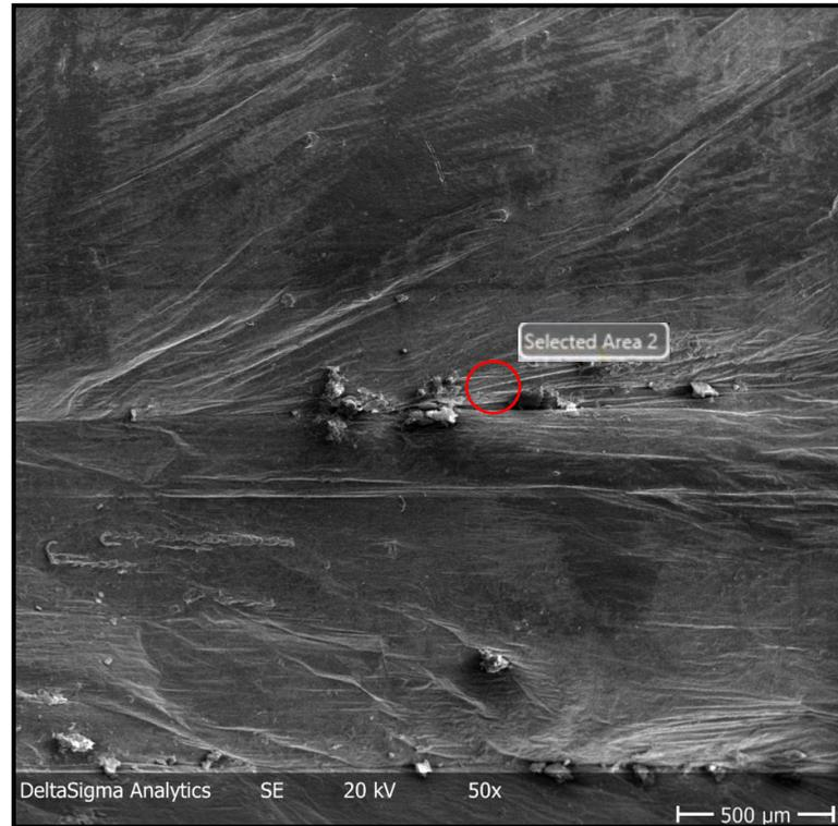
**Abbildung 73:** SE-Aufnahme einer Oxidhaut mit Falte einer AlMn1Mg1 – Legierung
