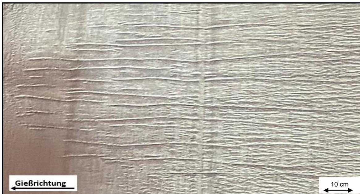
**Abbildung 20:** Oberflächenfalte einer AlMg<sub>4,5</sub>Mn<sub>0,3</sub>-Legierung
