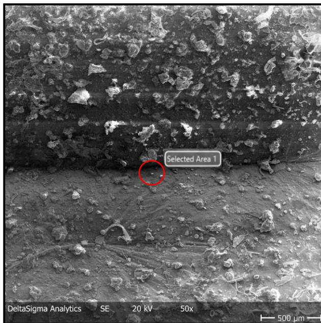
**Abbildung 72:** SE-Aufnahme einer Oxidhaut mit Falte einer AlMg<sub>4,5</sub>Mn<sub>0,4</sub> – Legierung
