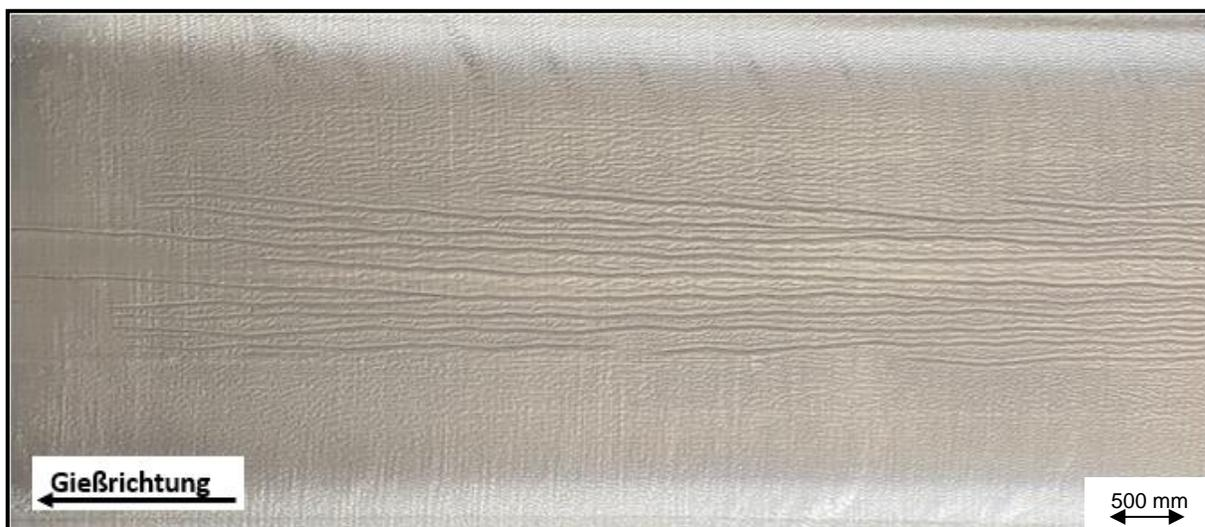
**Abbildung 23:** Kontinuierlich vertikale Mittelfalten
