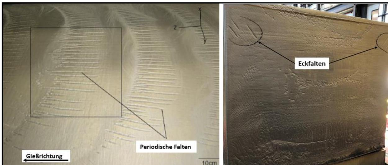
**Abbildung 22:** Periodische Oberflächenfalten (links) und Eckfalten (rechts) [83]
