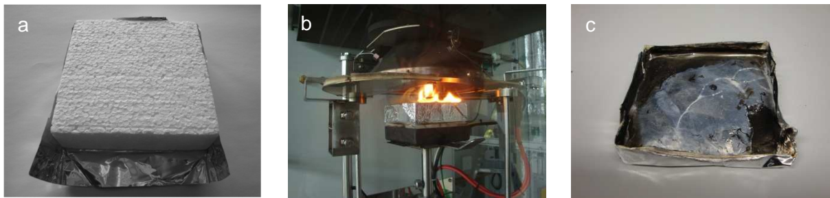
Abbildung 6-13: Polystyrol B1 a) vor, b) während und c) nach der Beaufschlagung mit 70 kW/m 2 im Cone Calorimeter
