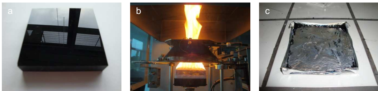
Abbildung 6-8: Polymethylmethacrylat Platte a) vor, b) während und c) nach der Beaufschlagung mit 70 \text{ kW/m}^2 im Cone Calorimeter
