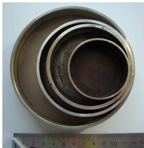
Abbildung 5-4: Prüfgefäße für Flüssigkeiten am Cone Calorimeter
