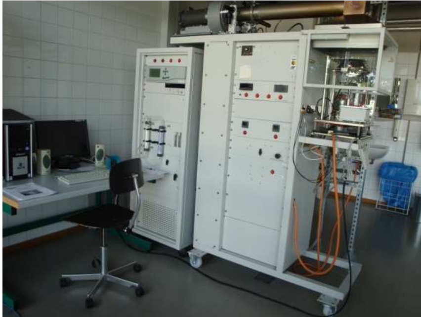
Abbildung 5-1: Cone Calorimeter der Hochschule Magdeburg-Stendal
