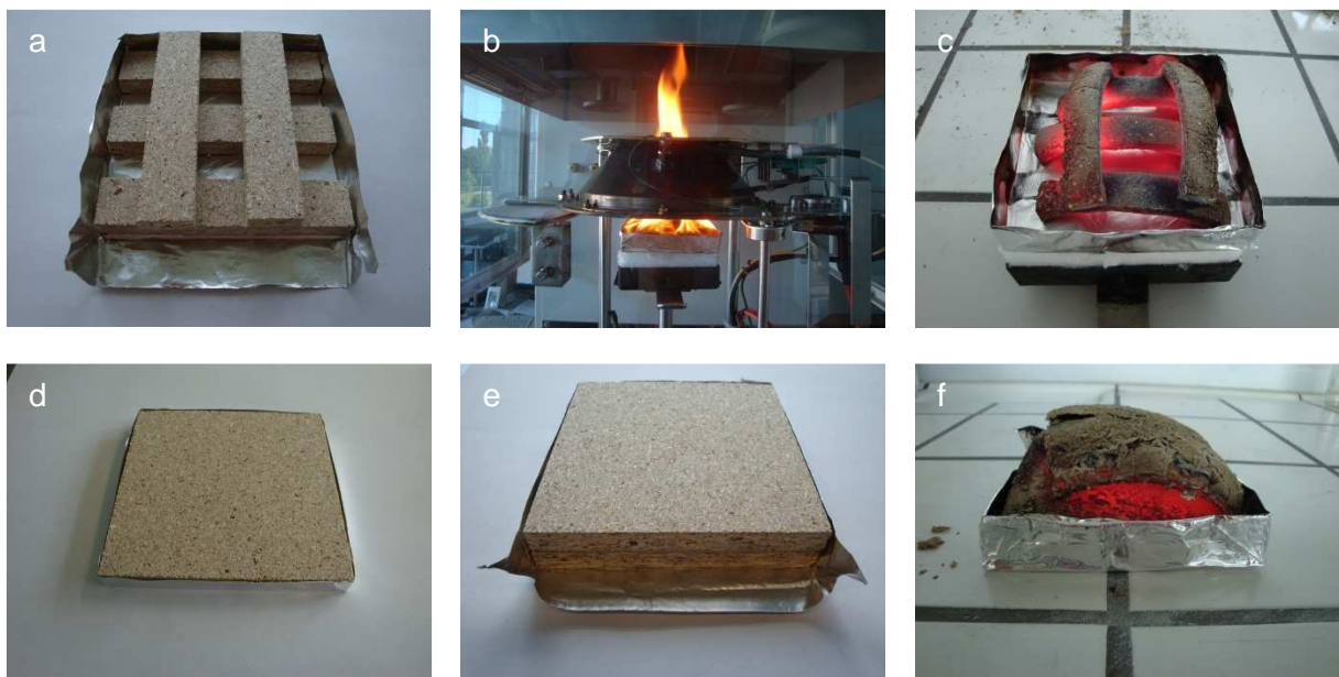
Abbildung 6-3: Rohspan P2: oben Krippe a) vor, b) während und c) nach der Beaufschlagung mit 35 \text{ kW/m}^2 sowie unten: d) Platte vor, e) 2 x Platte vor und f) 2 x Platte nach der Beaufschlagung mit 35 \text{ kW/m}^2 im Cone Calorimeter
