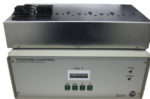
Abb. 18: Gerät für die nicht-invasive Bestimmung des Blutdrucks bei Mäusen. (eigenes Foto)
