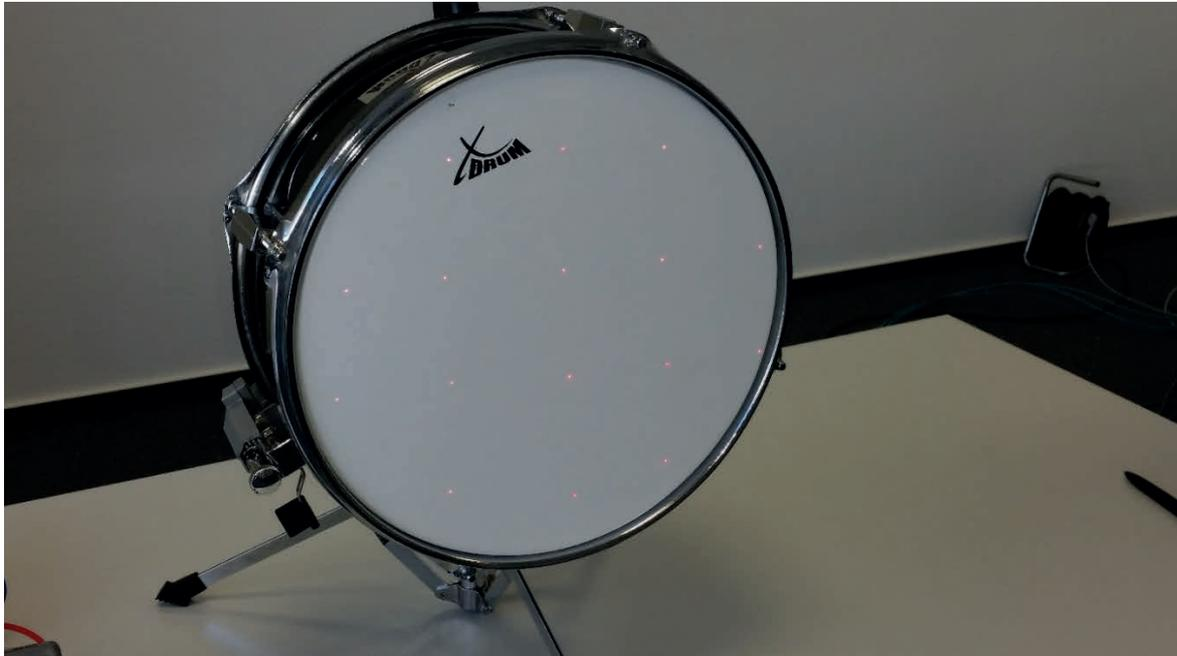
*Bild 13: Messpunkte auf der Membran der Trommel, © Polytec*
