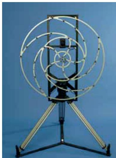
**Bild 7:** Mikrofon-Array mit 5-facher Spirale
