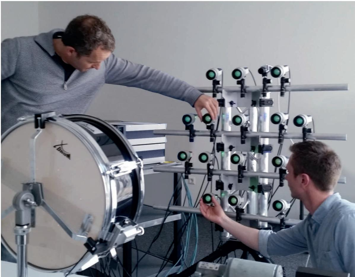
**Bild 3:** Multipoint Vibrometer mit 16 zeitsynchron messenden Kanälen, © Polytec
