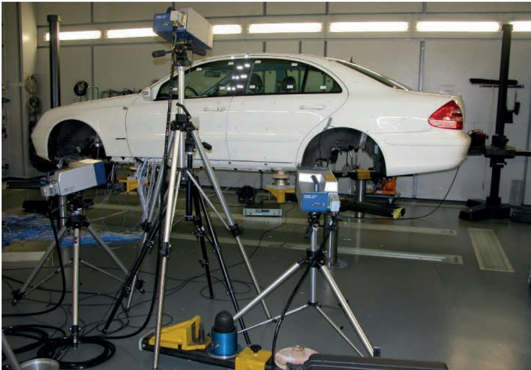
*Bild 1: 3D-Scanning-Vibrometer-Aufbau aus dem Jahre 2005*
