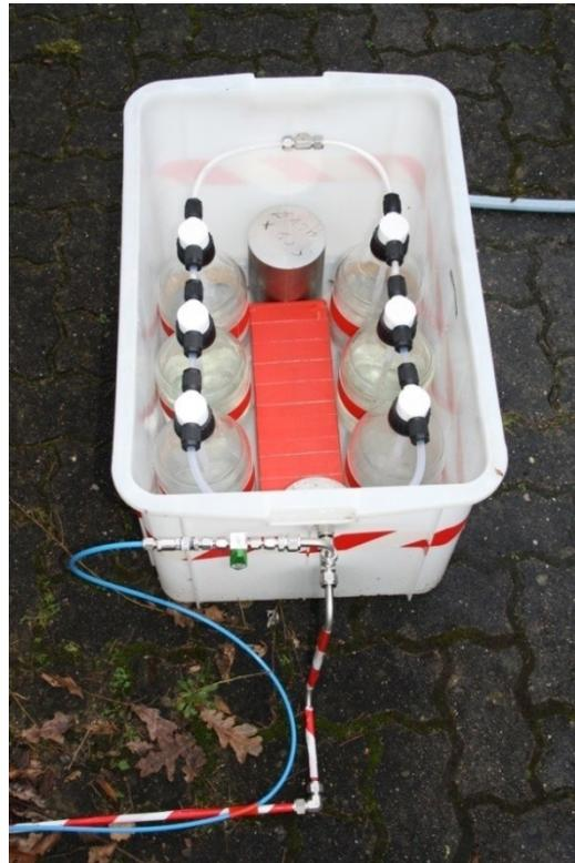
**Abbildung 3.14 Waschkolonne mit regulierbarer Luftzuführung**
