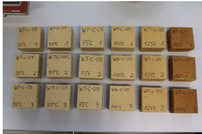
**Abbildung 4.7:** Proben von WT-c-05 nach unterschiedlicher Temperaturbeanspruchung
