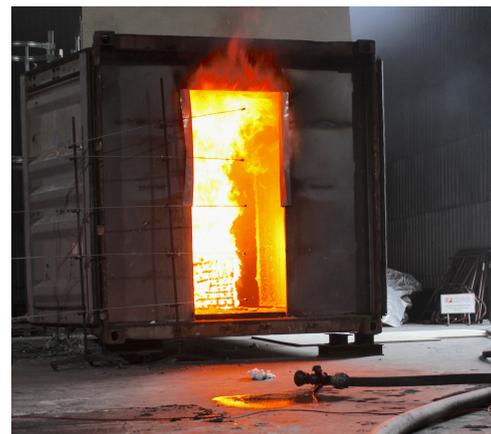
**Abbildung 7.2:** Brandraumtemperaturen in unterschiedlichen Höhen und Foto des Versuchsaufbaus (mit freundlicher Genehmigung [121])
