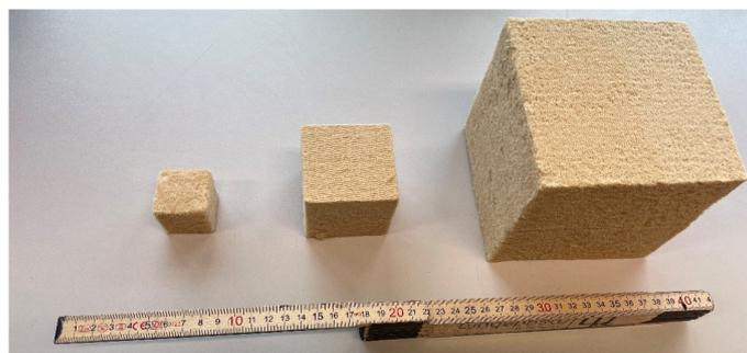
**Abbildung 4.9:** Würfel aus Holzfaserdämmstoff mit den Kantenlängen 30 mm, 60 mm und 120 mm
