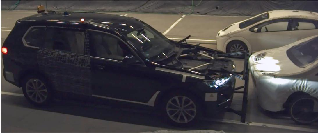
Abbildung 6.13: Kollision des Ego-Fahrzeugs mit dem Soft-Crash-Target. Zum Schutz der Forschungssensorik wurde ein Schutzbügel am Versuchsfahrzeug montiert.
