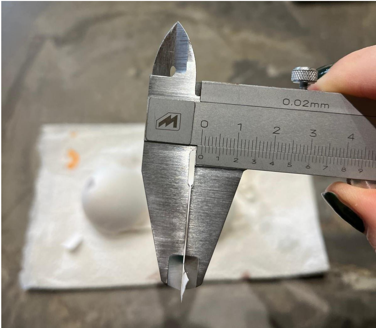
Abbildung 11: Messung Eischalendicke mittels Schiebelehre
