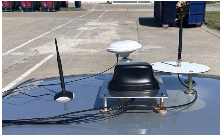
Abb. 2: Antennenaufbau auf dem Versuchsfahrzeug Bild: Eigene Darstellung
