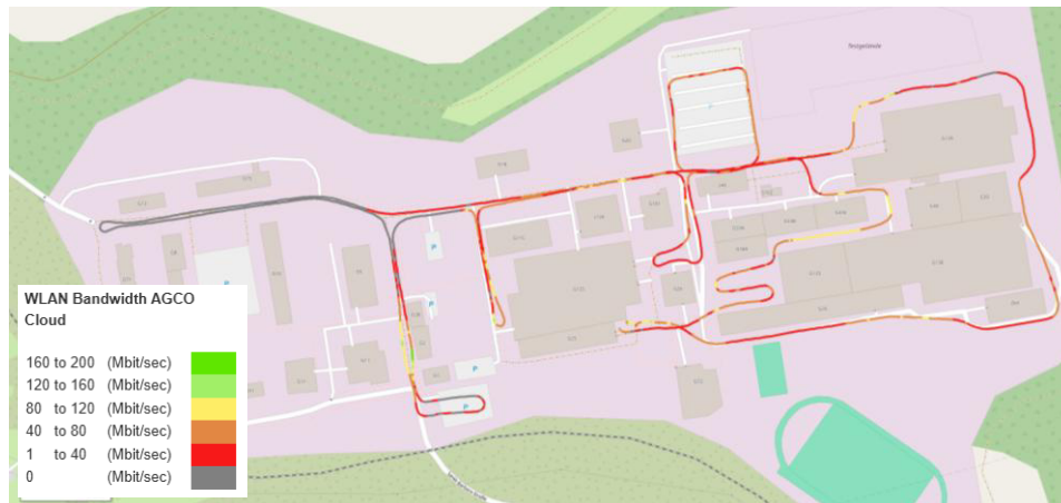
Abb. 3: Werksgelände mit WLAN-Bandbreite auf Straßenabschnitten, Bild: Eigene Darstellung auf Leaflet-Kartenbasis OpenStreetMap & Contributors.
