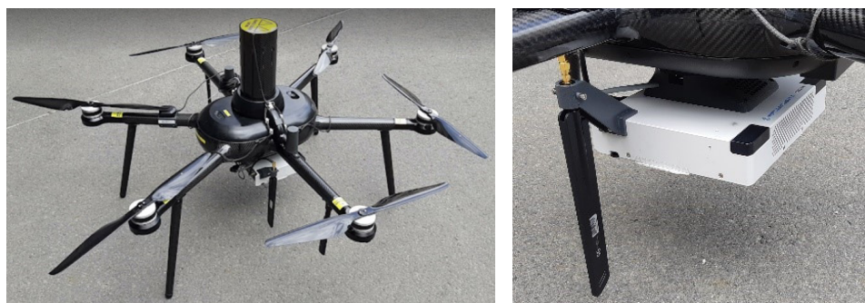
Abb. 2: Nokia-Drohne mit Netzwerkscanner TSMA6B als Payload.
