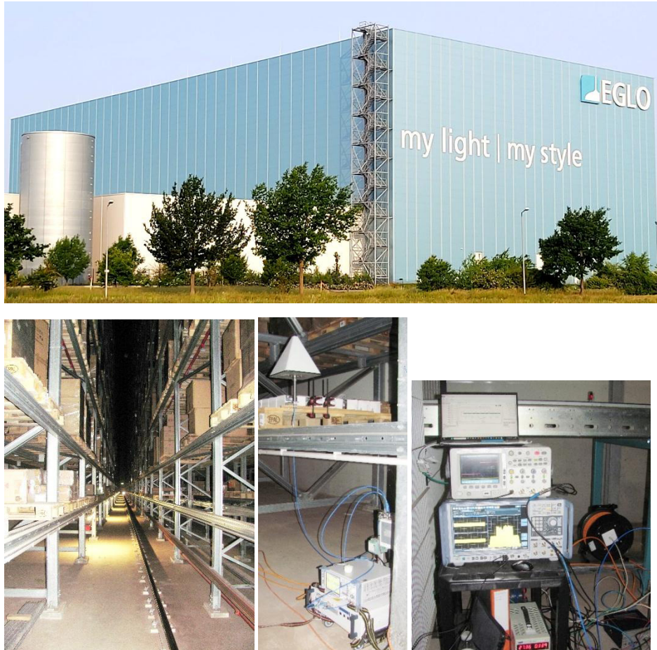
Abb. 9: Fotos des Hochregallagers (oben: Außenansicht, unten, v. l.: Gang, Senderaufbau, Empfängeraufbau)
