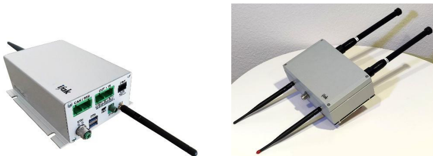
Abb. 7: ifak C-ITS Onboard unit (links) und Roadside unit (rechts)
