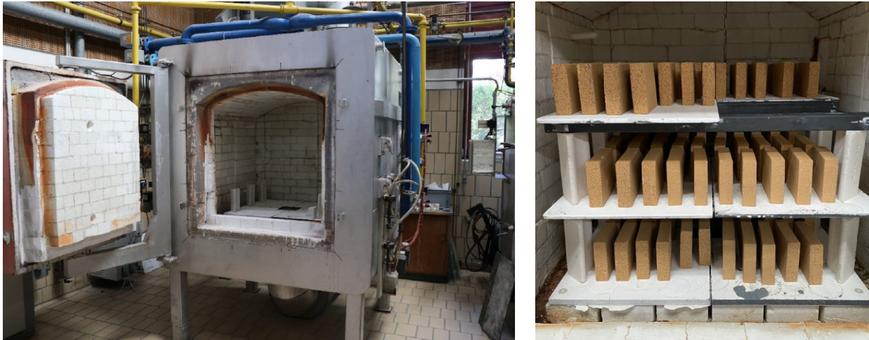
Abbildung 20: Sintern der Formkörper in einem Erdgas-befeuerten Hochtemperatur-Kammerofen der Firma L. Riedhammer.
