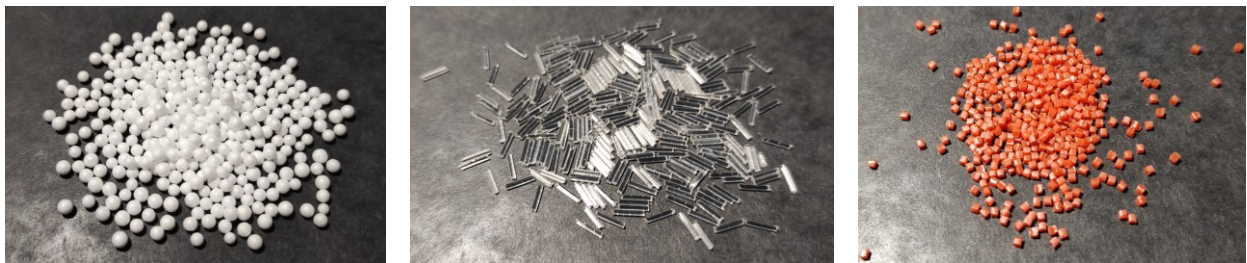
Abbildung 14: Verwendete organische Porosierungsmittel zur Erzeugung von Poren mit einfachen Geometrien in Cordierit-Keramik. Siebfraktion von EPS-Kügelchen zwischen 2,0 mm und 2,5 mm Maschenweite (l). PLA-Zylinder mit einer Höhe von 5,3 mm und einem Durchmesser von 0,9 mm (m). Kubisches PA6-Granulat mit einer Kantenlänge von 1,5 mm (r).
