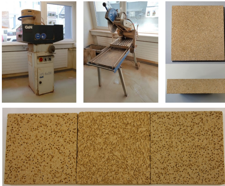
Abbildung 23: Kappsäge der Firma HeDia (o.l.), Oberflächenschleifmaschine der Firma G&N (o.m.) und fertig nachbehandelte Proben zur Bestimmung der Scherbenwärmeleitfähigkeit \lambda_{10, tr.} mittels der Guarded Hot Plate Methode mit dem Maßen 100 mm x 100 mm x 25 mm (u).
