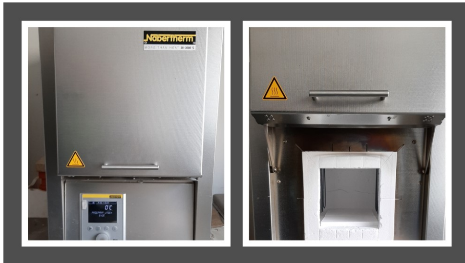
Abbildung 22: Elektrisch betriebener Hochtemperaturofen der Firma Nabertherm vom Typ LHT 08/16 für die Sinterung der manuell extrudierten Probekörper.
