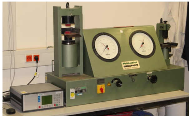
Abbildung 29: Universalprüfmaschine der Firma Weissgerber/Seidner-GmbH und Co zur Analyse der Druckfestigkeit.
