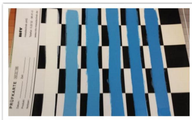
Bild 4: Prüfkarte mit Blindwertauftragung des Weißpastes-Ansatzes und Pigment-Ansatzes
