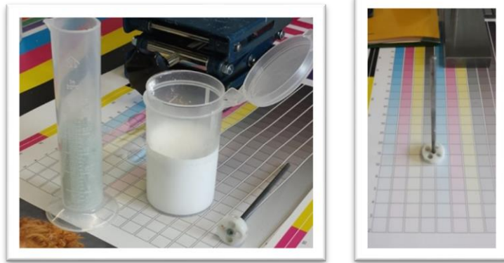
Bild 3: Weißpaste mit Glasperlen und Lochscheiben-Rührer
