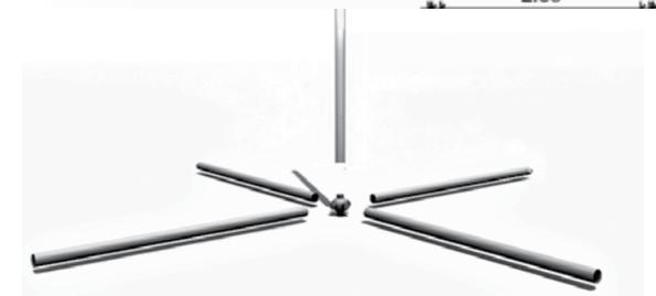
Der Pavillon wird mit einem sogenannte Mero-System konstruiert und ist endlos erweiterbar.
